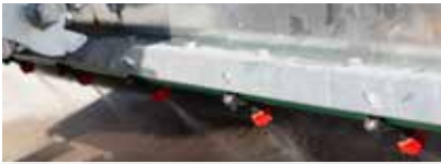
Dispositif d'arrosage – les buses de protection anti-éclaboussures protégées sur le carter pulvérisent l'eau près de la brosse et empêchent la production de poussière
