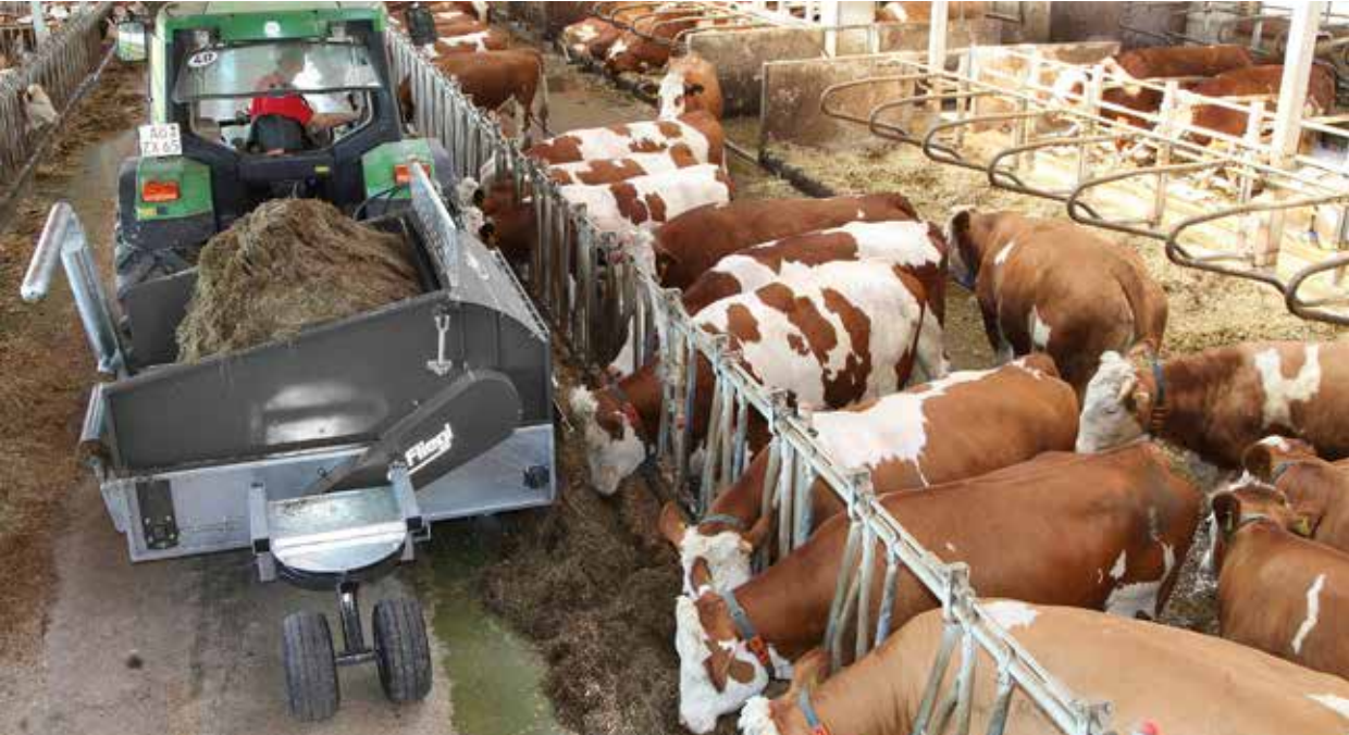
Avec châssis type remorque (en option) – répartition optimale du poids et décharge de l'hydraulique du tracteur
