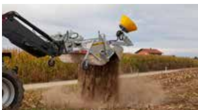
Avec attelage trois points, cuve de collecte des déchets hydraulique, balai latéral et roues porteuses
