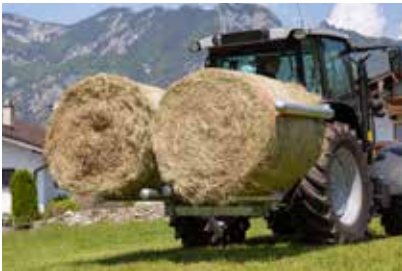
Largeur de travail réglable sur 5 positions de 50 mm chacune
