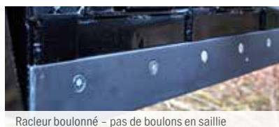
Racleur boulonné – pas de boulons en saillie
