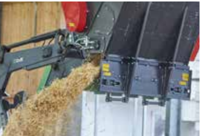
3 rouleaux de dosage avec couteaux
