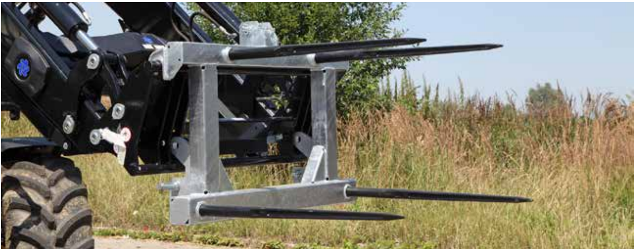
Version standard, ici avec 4 dents de balle ronde (2 dents de série)
