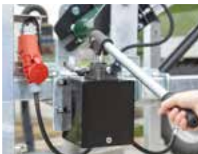
Pompe manuelle pour le réglage en hauteur de la bande de convoyage
