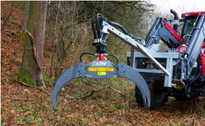
Grappin avec rallonge de crochet de levage, rotateur, attelage Euro et trois points
