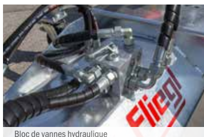
Bloc de vannes hydraulique
