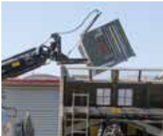
Angle de basculement jusqu'à env. 71°
