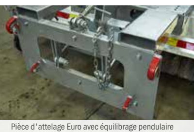
Pièce d'attelage chariot élévateur avec équilibrage pendulaire
