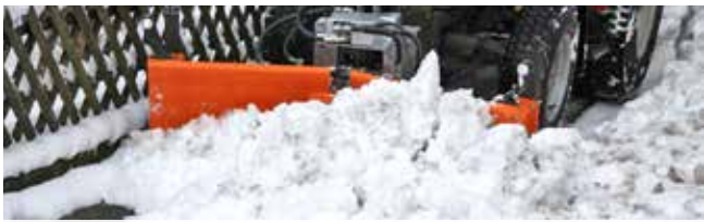
2 panneaux à orientation hydraulique avec commande séparée
