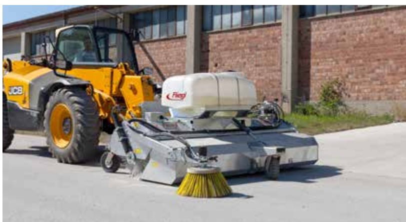
Brosse de balayage réglable en continu – utilisable jusqu'à la limite d'usure extrême
