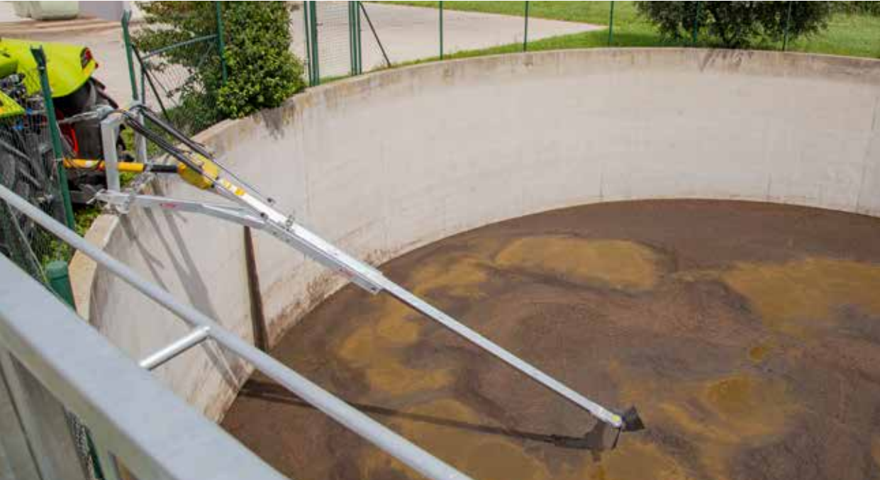
Avec repliage hydraulique – utilisable pour les fosses à lisier profondes
