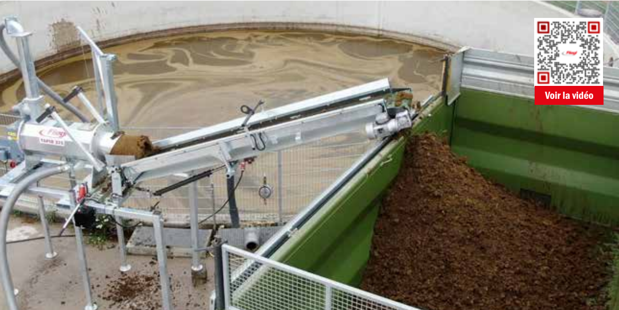
Bande de convoyage de 4 m pour charger les matières solides (en option)
