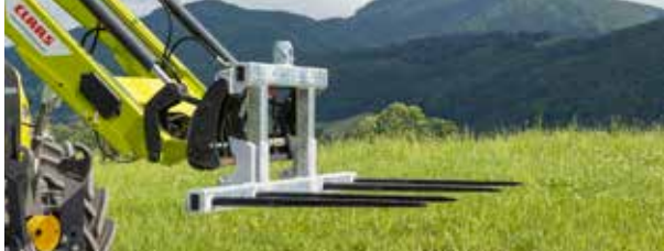
Version standard avec 4 dents de balle ronde (de série)
