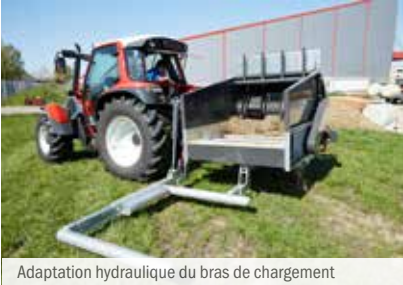
Adaptation hydraulique du bras de chargement
