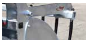
Parois latérales dévissables pour des possibilités d'utilisation étendues, comme par ex. le transport sans perte d'ensilage haché court ou de fumier pâteurs
