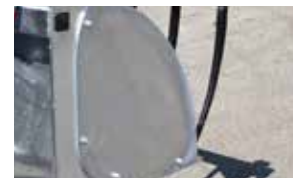
La courbure du godet avec des parois latérales renforcées augmente la stabilité
