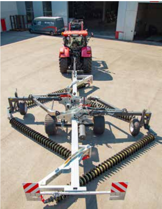
Angle d'attaque agressif de 55°
