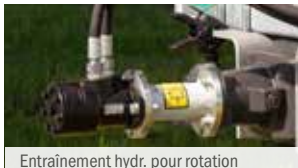
Entraînement hydr. pour rotation droite / gauche
