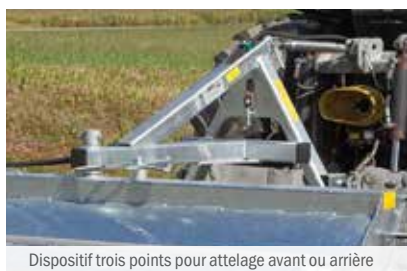
Pièce d'attelage Euro avec équilibrage pendulaire
