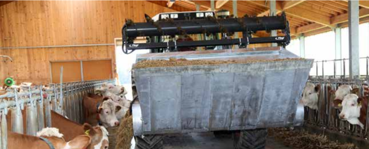
Godet distributeur, ici avec rouleau fraiseur (non compris dans la livraison)
