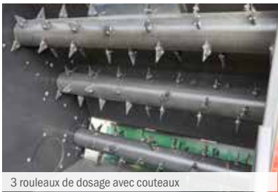
3 rouleaux de dosage avec couteaux
