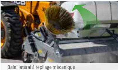
Balai latéral à repliage mécanique
