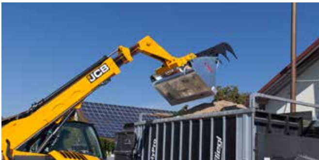
Dents en acier HB 500 très résistant à l'usure (épaisseur 20 mm)
