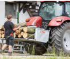
La paroi pendulaire rabattable sert de rallonge au godet
