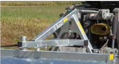
Dispositif trois points pour attelage avant ou arrière
