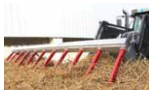
Les douilles coniques sont présoudées dans un porte-dents robuste
