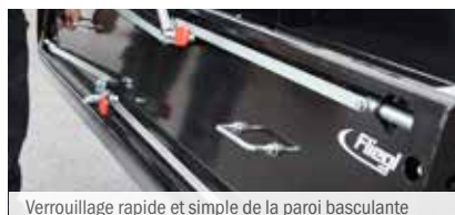
Verrouillage rapide et simple de la paroi basculante
