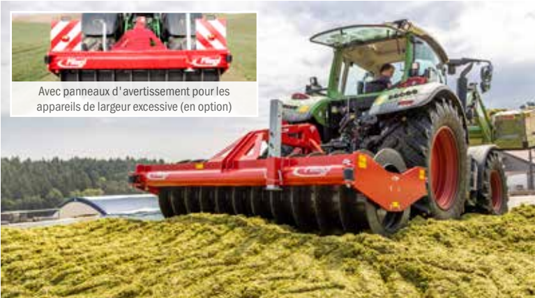
Rouleau de tassement à déport bilatéral
