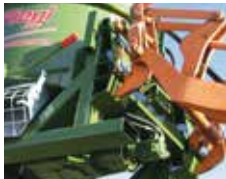
Entraînement hydraulique et attelage chargeur
