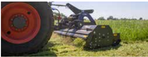
Volet réglable pour déposer les matériaux broyés en toute sécurité
