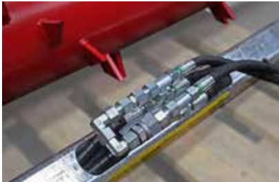
Guidage interne des tuyaux, tubes de support robustes – protection optimale des tuyaux
