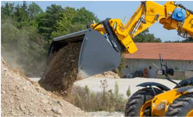
Construction conique pour un meilleur glissement des matériaux en vrac
