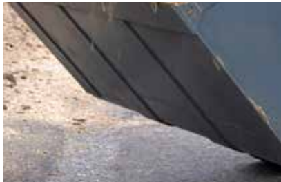
Les tôles de renfort assurent une structure robuste
