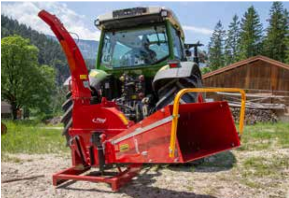
Angle d'ouverture du bec d'éjection réglable
