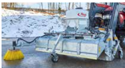
Avec attelage trois points, cuve de collecte des déchets hydraulique, balai latéral et roues porteuses
