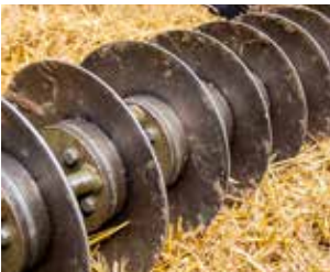
Disques en acier résistants à l'usure
