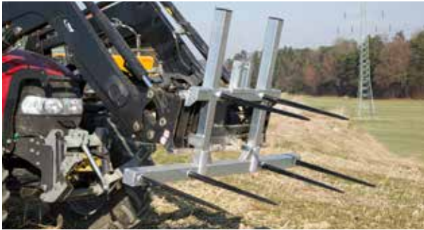
Version avec rehausse et 6 dents de balle ronde (4 dents de série)
