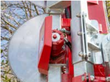
Entraînement des lames de scie via des moteurs hydrauliques
