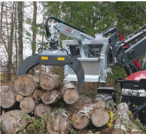
Grappin »RZ 185 Combi-Plus« hydraulique avec lame de remblayage (en option)
