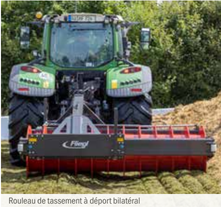
Rouleau de tassement à déport bilatéral
