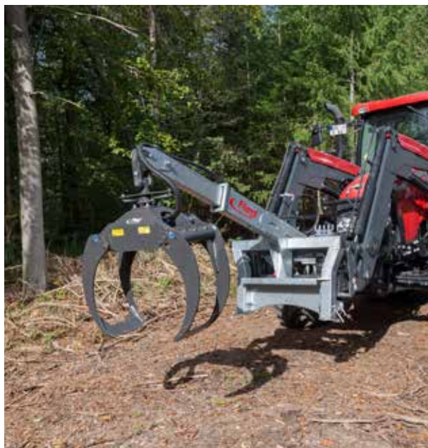
Grappin »LongNeck Combi« hydraulique avec articulation mécanique
