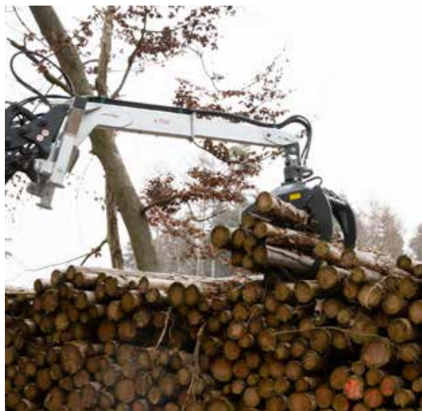
Grappin »LongNeck Combi-Plus« hydraulique avec rotateur
