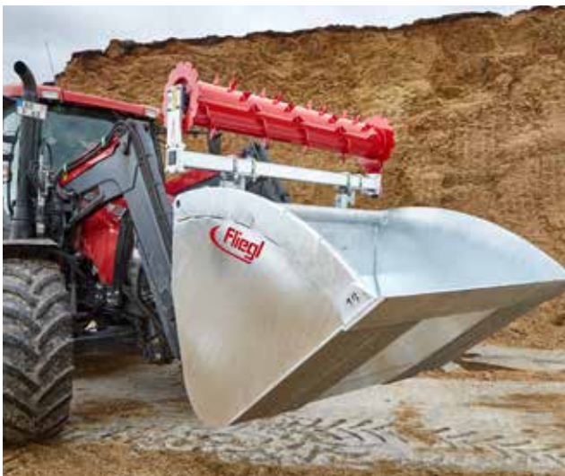
En combinaison avec notre godet grande capacité (montage à l'usine en option)
