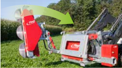
Tête de lamier à scies orientable pour montage à droite et à gauche
