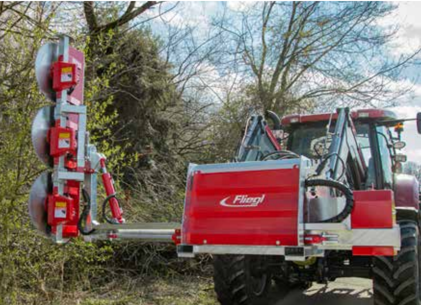
Tête de scie plate de forme spéciale pour une meilleure visibilité – convient à la perfection pour couper les arbustes ou les grosses broussailles
