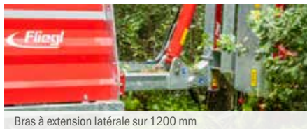
Bras à extension latérale sur 1200 mm
