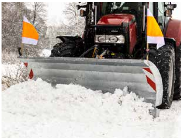
Finition galvanisée (de série) et drapeaux de signalisation (en option)
