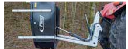
2-Zylinder-System für besten Kippwinkel 111°
