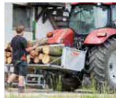
Ausklappbare Pendelwand dient als Muldenverlängerung
