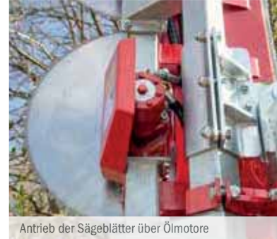
Antrieb der Sägeblätter über Ölmotore
