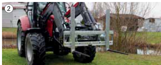
Verstellbare Aufnahme für Rundballenzinken (Schwerlastzinken; M28 x 1,5).
