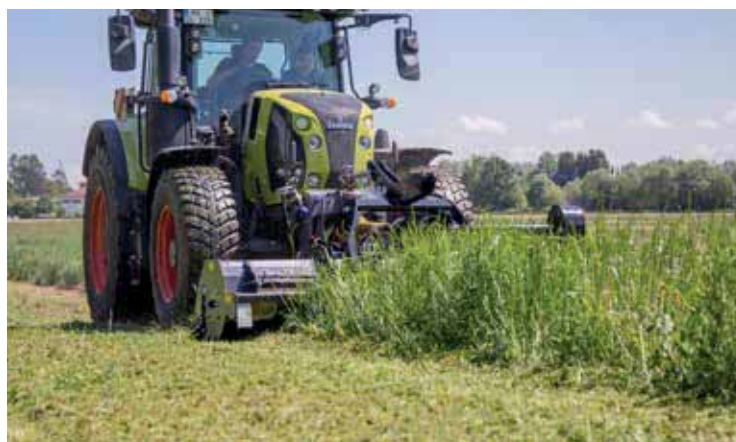
Einstellbare Klappe für das sichere Ablegen des Mulchguts
