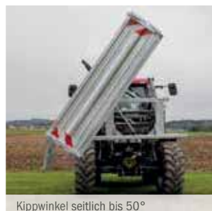
Kippwinkel seitlich bis 50°
