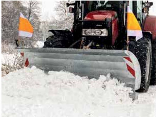
»Mammut Mono« verzinkt, Schildhöhe: ca. 955 mm (Warnflaggen optional)
