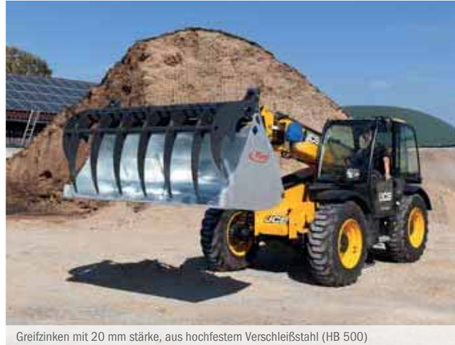
Greifzinken mit 20 mm Stärke, aus hochfestem Verschleißstahl (HB 500)
