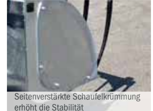
Hochfeste, robuste Schürfleiste schont den Schaufelunterbau
