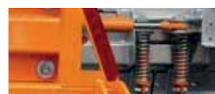
Überlastsicherung durch Federklappen gewährleisten beschädigungsfreies Fahren
