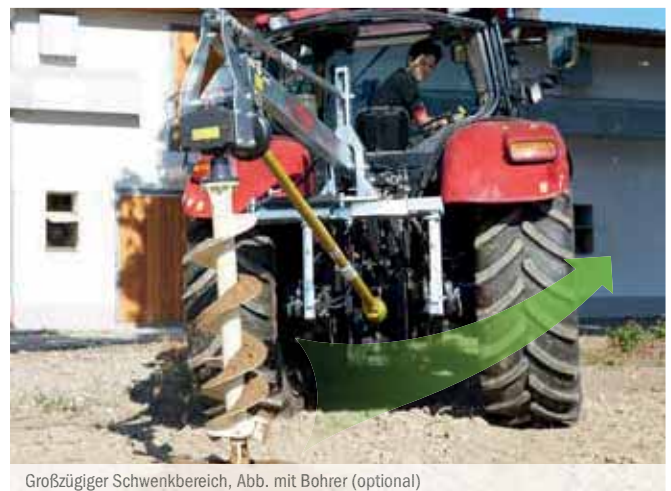
Großzügiger Schwenkbereich, Abb. mit Bohrer (optional)
