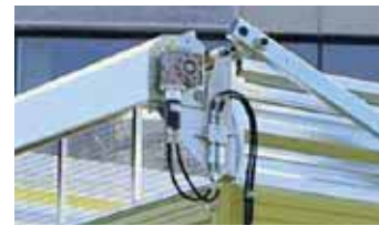
Hydraulisch angetriebener Ölmotor für das Einziehen des Abdecknetzes
