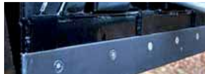
Geschraubte Schürfleiste, keine überstehende Schrauben
