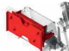
Überlastsicherung: Bei zu hohem Anpressdruck neigt sich der Kopf nach hinten zum Schutz vor Blockieren.
