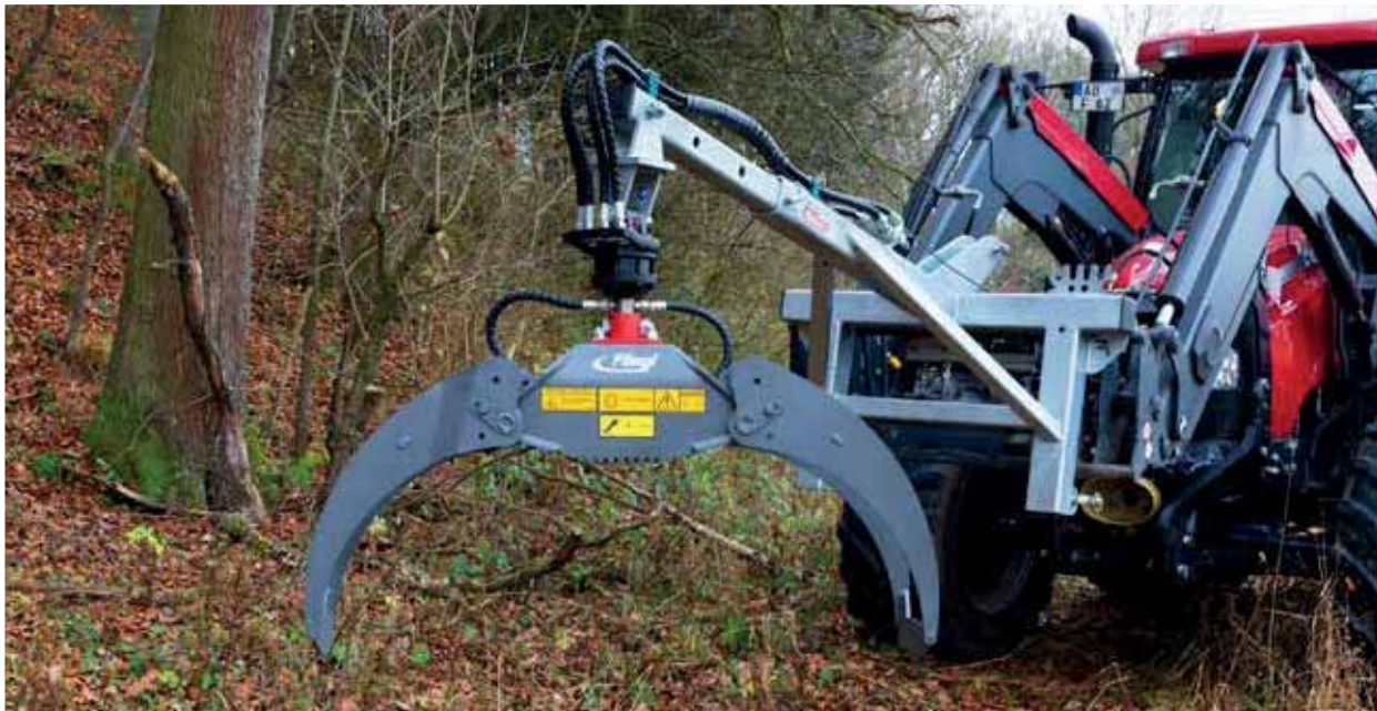
Verladezange mit Lasthakenverlängerung (Euro-Dreipunktaufnahme) & Drehmotor
