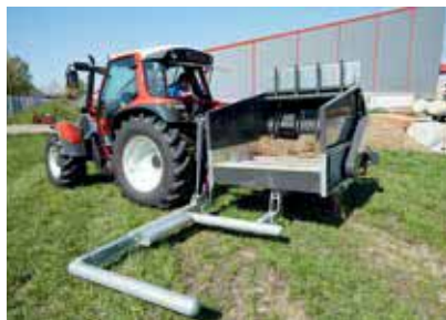
Abb. mit Fahrwerk dadurch optimale Gewichtsverteilung und Entlastung der Schlepperhydraulik
