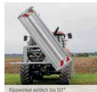
Kippwinkel seitlich bis 50°
