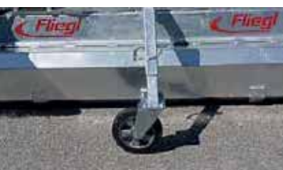
Stützrad vorne mit robustem Vollgummirad Ø 250 mm
