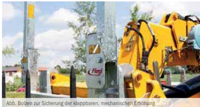
Abb. Bolzen zur Sicherung der klappbaren, mechanischen Erhöhung
