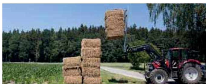
Abb. zeigt Ballengabel mit hydraulischem Niederhalter am Hubstapler - Transport von 3 Quaderballen möglich
