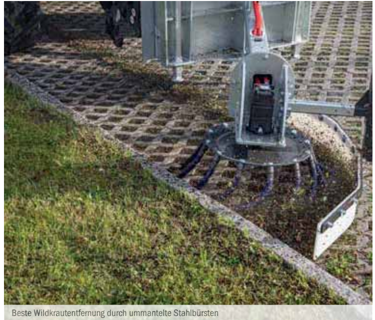
Beste Wildkrautentfernung durch ummantelte Stahlbürsten
