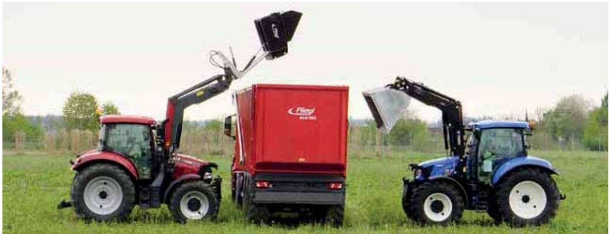
Darstellung der unterschiedlichen Kipphöhen bei gleichem Frontlader
