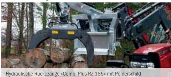
Hydraulische Rückezege »Combi Plus RZ 185« mit Polderschild
