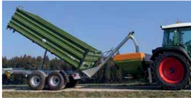
Die Überladeschnecke kann an jeden Kipper mit einfachster Montage angebracht werden. Die Bedienung ist mühelos. Stufenlose Verstellung des Austragewinkels mittels Seilwinde.
