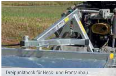
Dreipunktbock für Heck- und Frontanbau
