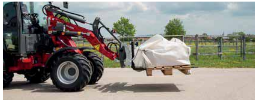
Abb. mit Schutzbügel bietet Schutz gegen Abrutschen, z.B. bei Holzstapel, Ballen, Stahlprofile u.v.m. - nachträglich einfach und schnell montierbar!
