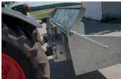
Beonders robuste Ausführung durch Versteifungen an den Stirnseiten der Heckschaufel
