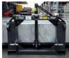
Aufnahmemöglichkeiten: Euronorm- und Dreipunkt- sowie Stapleraufnahme
