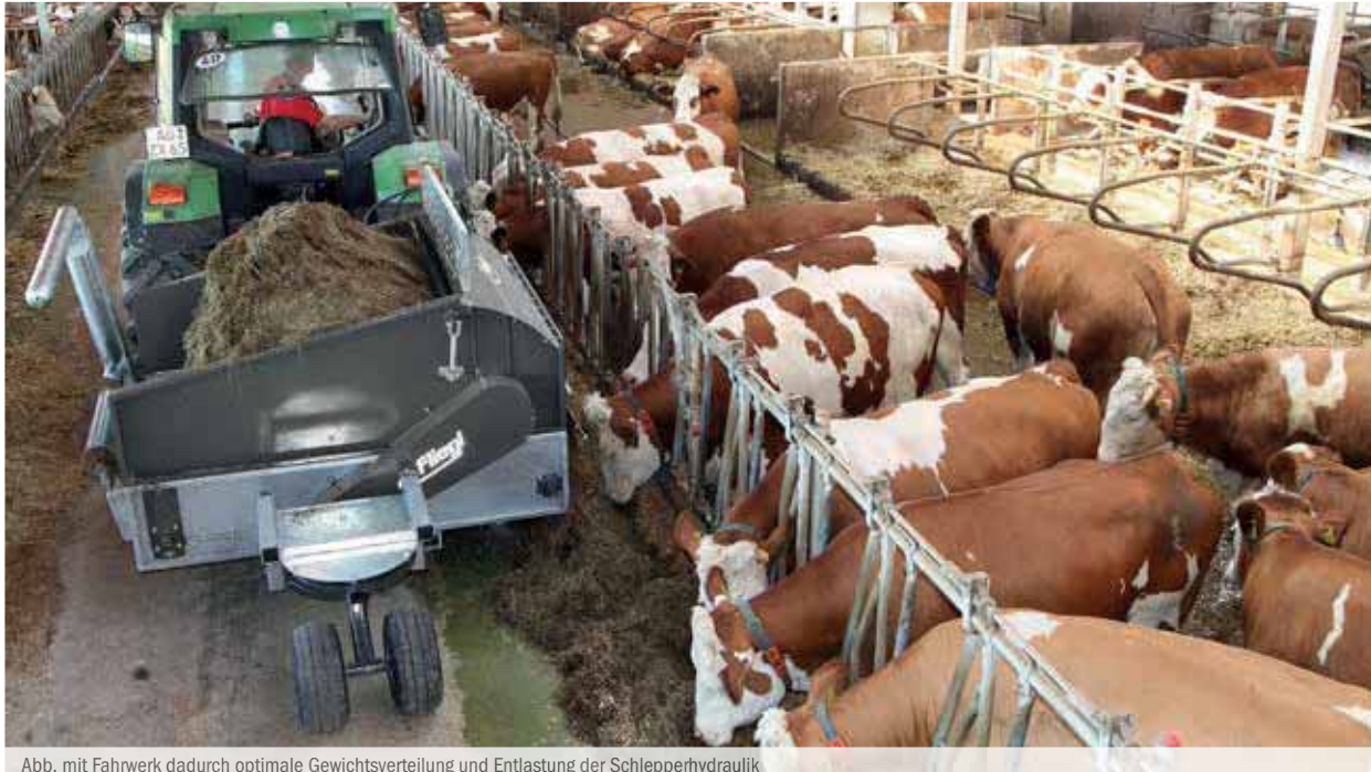
Abb. mit Fahrwerk dadurch optimale Gewichtsverteilung und Entlastung der Schlepperhydraulik
