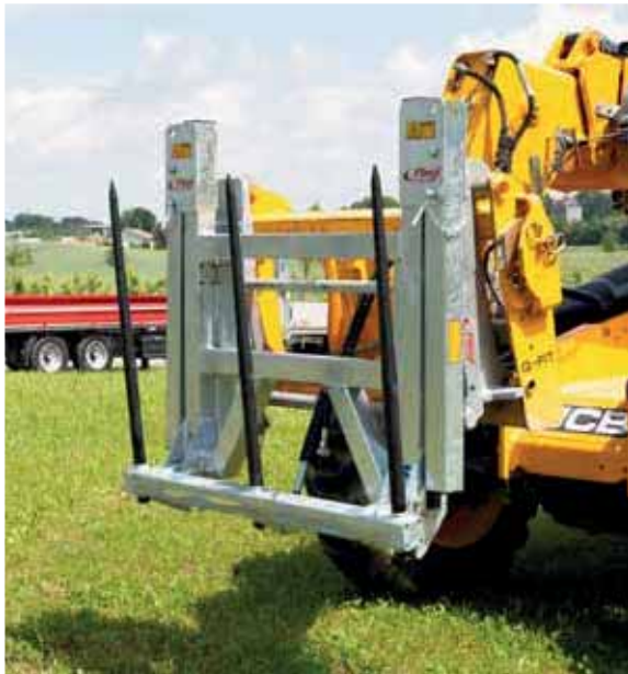
Abb. eingeklappte Ballengabel besonders kompakt
