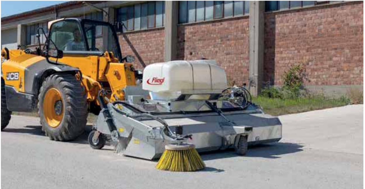
Stufenlos verstellbarer Kehrbesen, bis zur äußersten Verschleißgrenze abnutzbar
