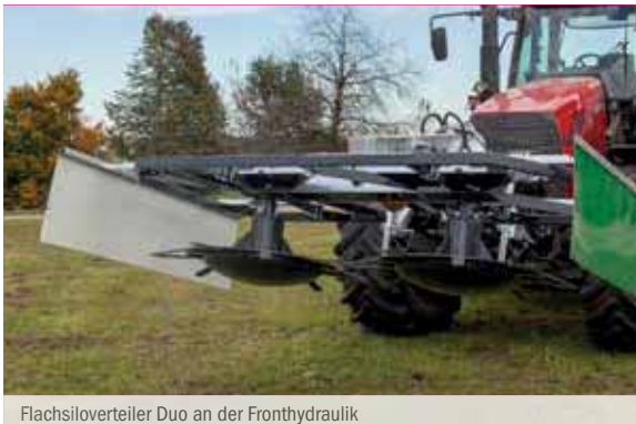
Flachsiloverteiler Duo an der Fronthydraulik
