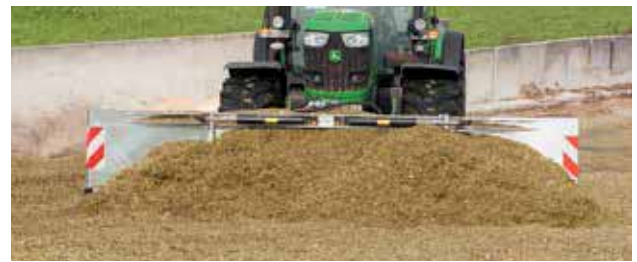
Die Räumbreite lässt sich durch die zwei Seitenflügel im vorgegebenen Bereich stufenlos einstellen.
