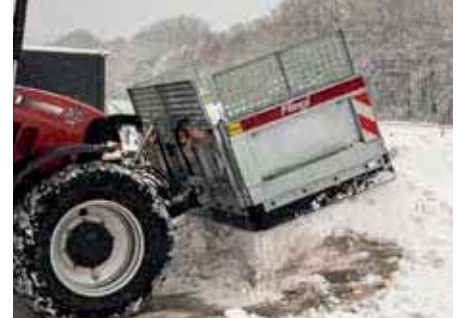
Die Räumbreite lässt sich durch die zwei Seitenflügel im vorgegebenen Bereich stufenlos einstellen.
