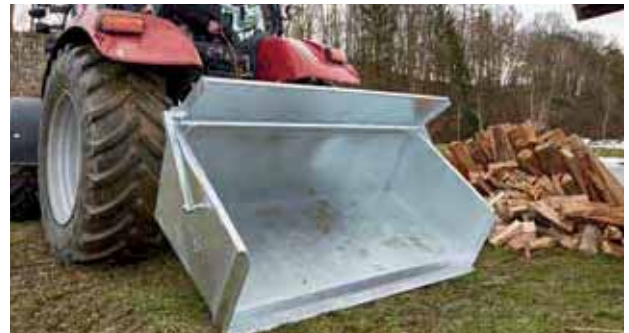
Mechanische Entleerung über Seilzug
