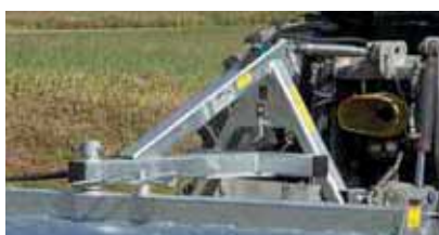
Dreipunktbock für Heck- und Frontanbau
