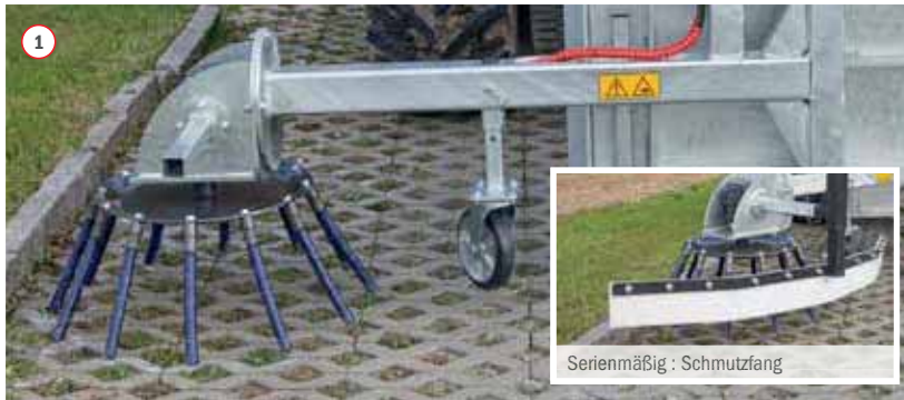
Beste Wildkrautentfernung durch ummantelte Stahlbürsten
