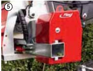
Seitliches Kontergewicht - dadurch minimale Belastung der Schwinge des Trägerfahrzeugs.
