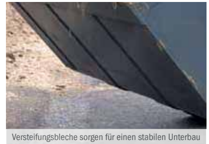
Versteifungsbleche sorgen für einen stabilen Unterbau
