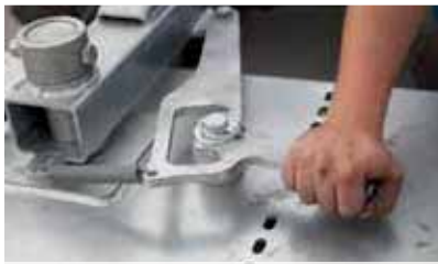
Schwenkbock mechanisch (30° nach links und rechts)
