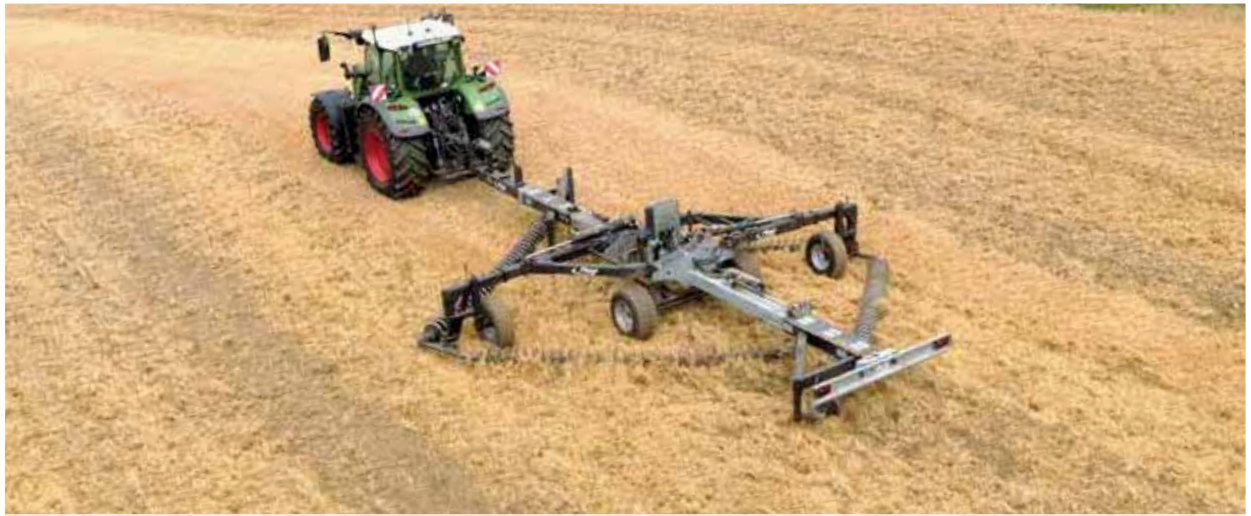
Schwere Ketten mit einstellbarer Bearbeitungsaggressivität
