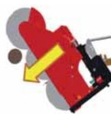
Hinweis: Starke Äste immer von oben nach unten schneiden, um ein Klemmen der Sägeblätter zu vermeiden!
