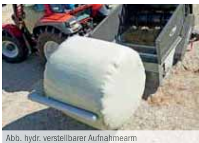
Abb. hydr. verstellbarer Aufnahmearm
