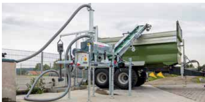
Abb. 3,5 Meter langes Förderband zum Auffangen des Feststoffs
