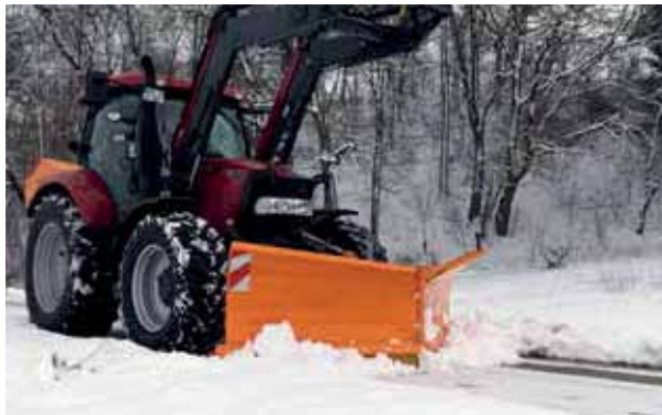
Abb. Verzinkt und zusätzlich Schutzlackiert für besten Rostschutz
