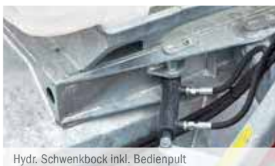
Hydr. Schwenkbock inkl. Bedienpult
