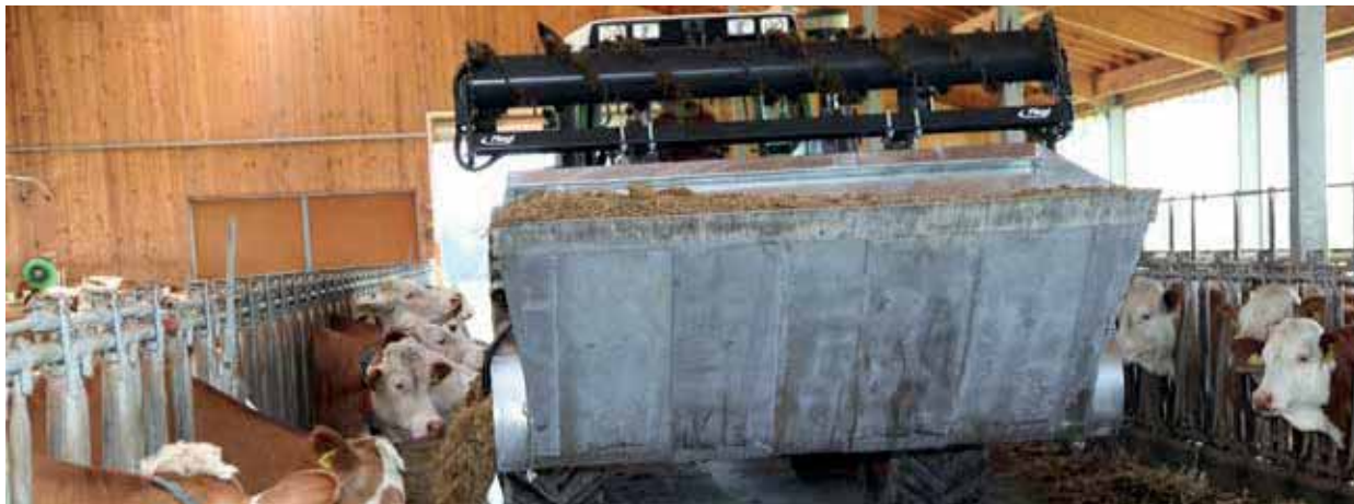
Abb. Einfütterschaufel mit Fräswalze (Fräswalze nicht im Lieferumfang enthalten)
