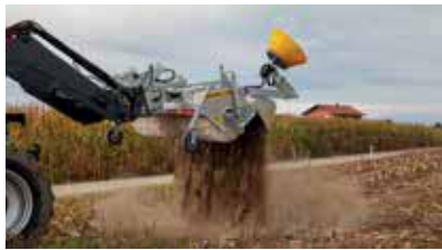
KEH Typ 500 mit Dreipunktaufnahme, hydraulische Schmutzsammelwanne, Seitenbesen und Frontstützrad
