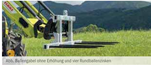
Abb. Ballengabel ohne Erhöhung und vier Rundballenzinken
