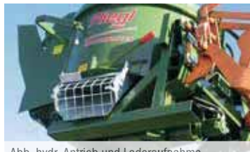
Abb. hydr. Antrieb und Laderaufnahme
