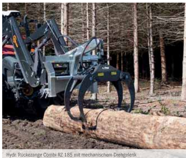
Hydr. Rückezege Combi RZ 185 mit mechanischem Drehgelenk
