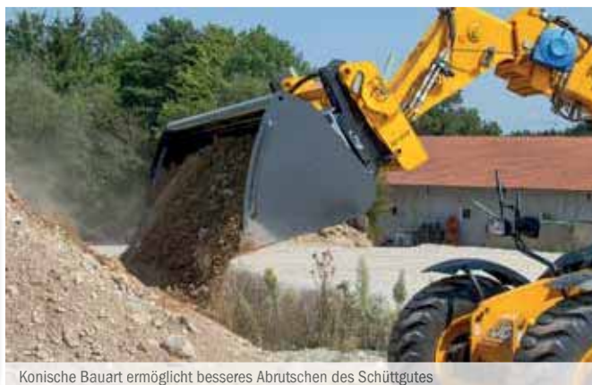
Konische Bauart ermöglicht besseres Abrutschen des Schüttgutes
