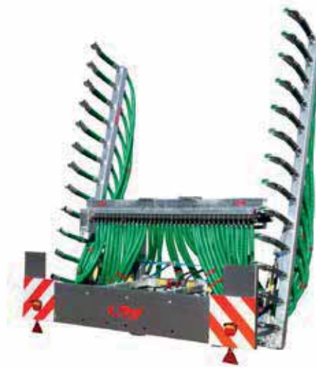
Abb. Transportschutz mit Beleuchtung und Warntafel
