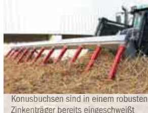
Hochfeste, robuste Schürfleiste schont den Schaufelunterbau
