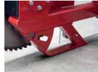
Ein Schutzbügel verhindert eine Berührung des untersten Sägeblattes mit dem Erdreich.
