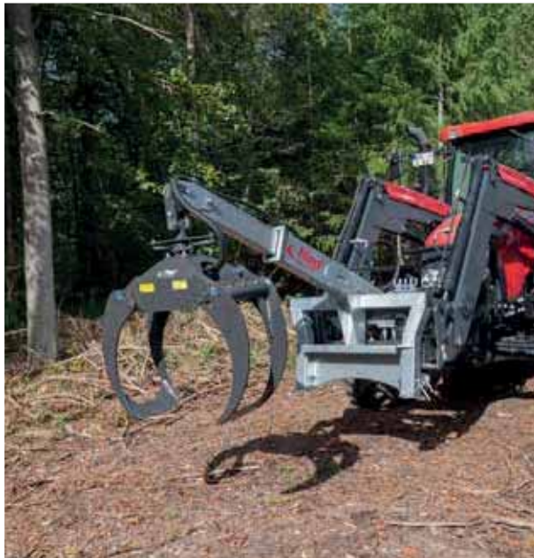
Hydraulische Rückezege LongNeck Combi mit mechanischem Drehgelenk
