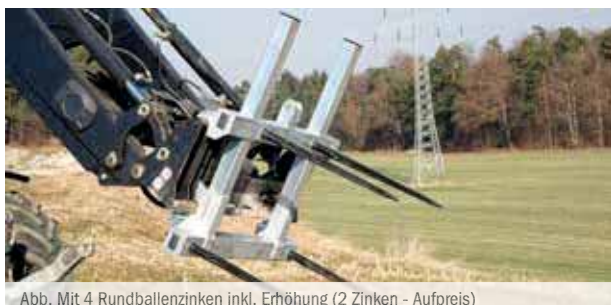
Abb. Mit 4 Rundballenzinken inkl. Erhöhung (2 Zinken - Aufpreis)
