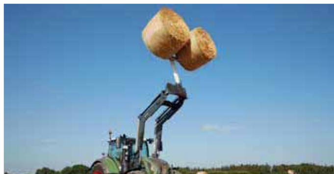
Abb. Hubstapler und Ballengabel mit hydr. Niederhalter (optional)
