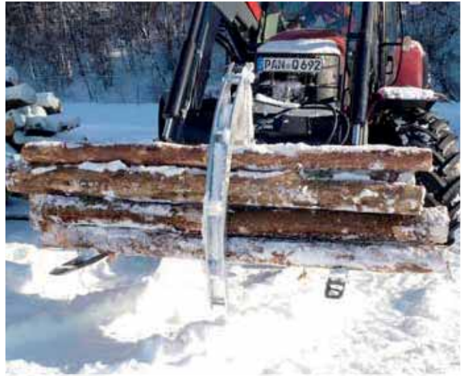
Hydraulischer Greifarm an der Staplergabel »Freisicht« befestigt
