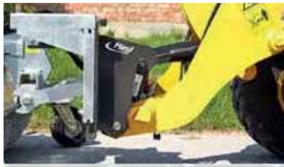
Radladeraufnahme mit Pendelausgleich
