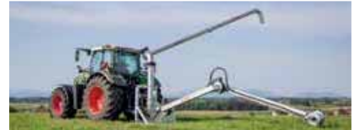
Vier variabel einstellbare Drehkränze für mehr Flexibilität
