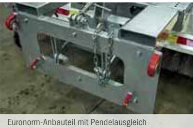
Euronorm-Anbauteil mit Pendelausgleich
