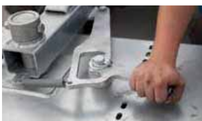
Tête pivotante mécanique (30° à gauche et à droite)
