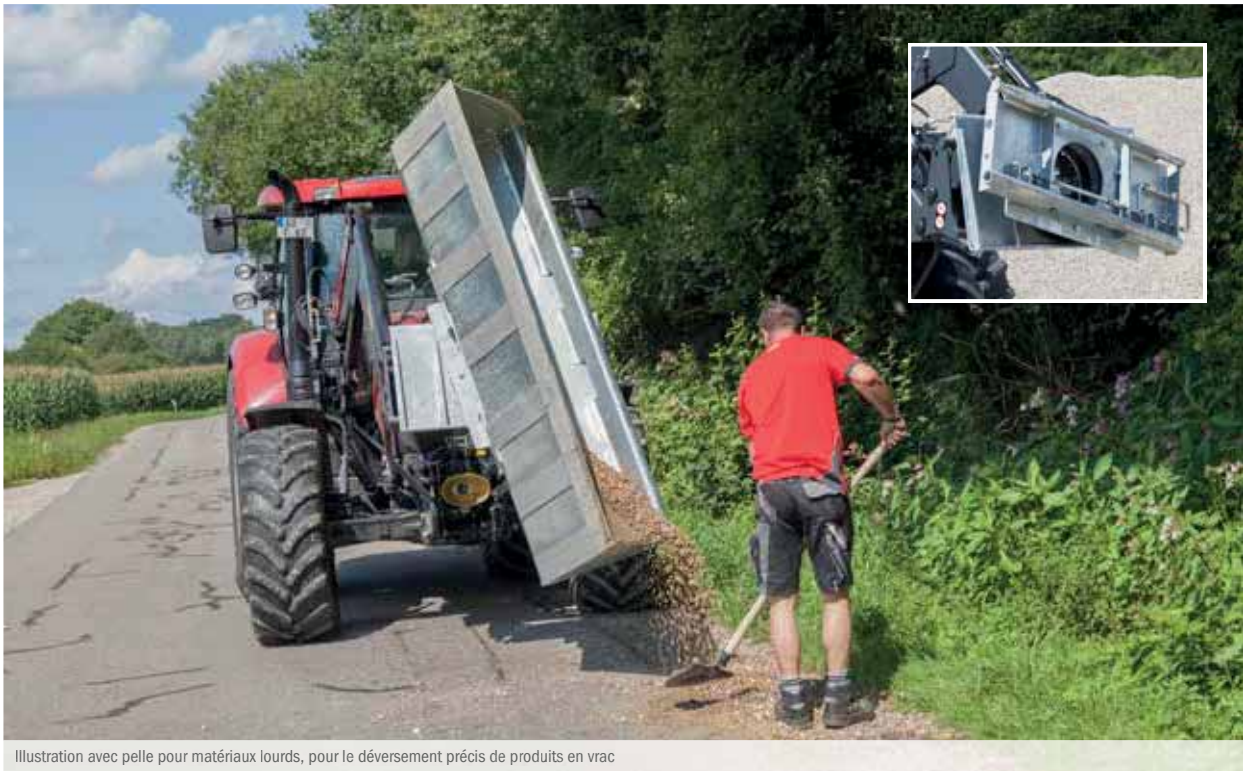
Illustration avec pelle pour matériaux lourds, pour le déversement précis de produits en vrac
