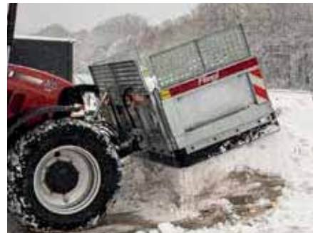
La largeur de déblayage peut être réglée en continu dans la zone définie à l'aide des deux panneaux latéraux.
