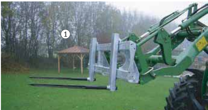
Système de fixation ajustable pour broches pour balles rondes (broches lourdes charges ; M28 x 1,5).
