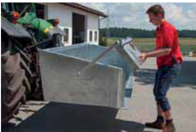
Modèle particulièrement robuste grâce aux renforcements à l'avant de la pelle arrière
