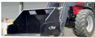
Structure avec découpe de visibilité pour volume maximum
