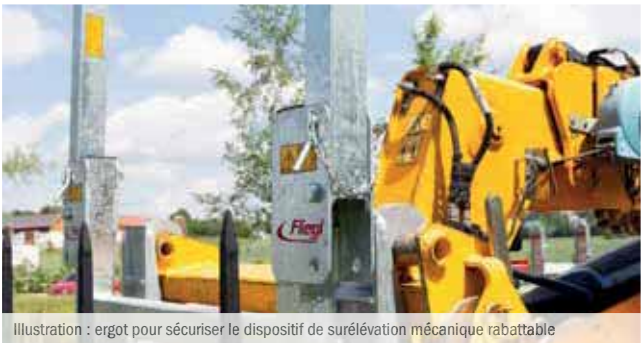
Illustration : ergot pour sécuriser le dispositif de surélévation mécanique rabattable
