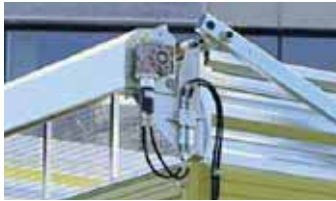
Moteur à huile à entraînement hydraulique pour le déploiement du filet de recouvrement
