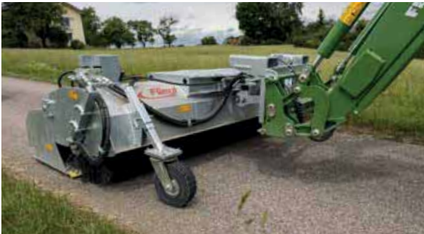
Balai réglable en continu, utilisable jusqu'à usure complète
