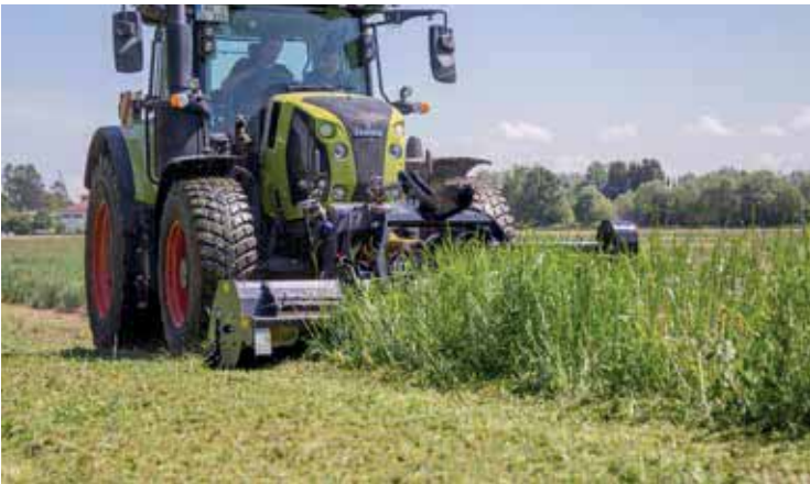
Volet réglable pour déposer les produits broyés en toute sécurité
