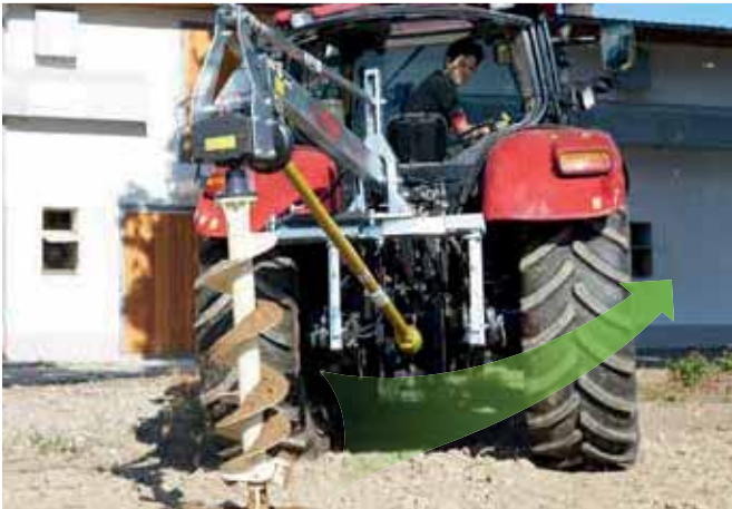
Zone d'inclinaison très large, illustration avec mèche (en option)
