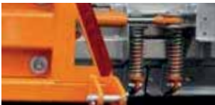
Limiteur de charge par clapets à ressorts garantissant une conduite sans dommages
