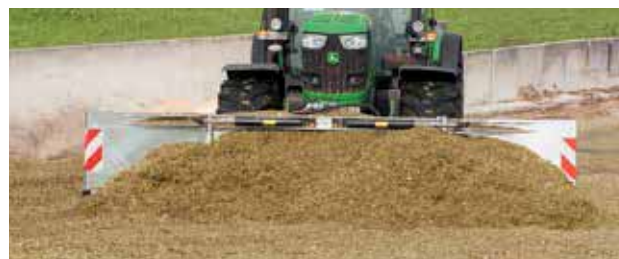
La largeur de déblayage peut être réglée en continu dans la zone définie à l'aide des deux panneaux latéraux.
