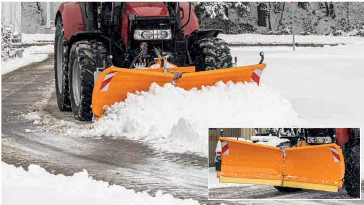
2 panneaux à inclinaison hydraulique - peuvent être commandés séparément pour choisir des positions individuelles en équerre, en chasse-neige ou en V.
