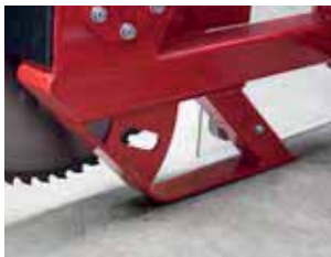
Un arceau de sécurité empêche tout contact de la lame de scies inférieure avec le sol.
