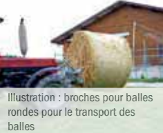
Illustration : broches pour balles rondes et broches pour chariot élévateur
