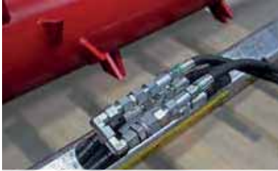
Guidage des tuyaux à l'intérieur, tubes de maintien robustes, donc protection optimale des tuyaux
