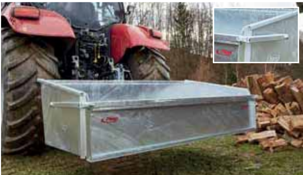
Modèle particulièrement robuste grâce aux renforcements à l'avant de la pelle arrière
