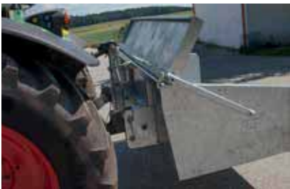
Modèle particulièrement robuste grâce aux renforcements à l'avant de la pelle arrière
