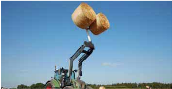
Illustration : surélévateur et pique botte à fond poussant avec serre-flan hydr. (en option)
