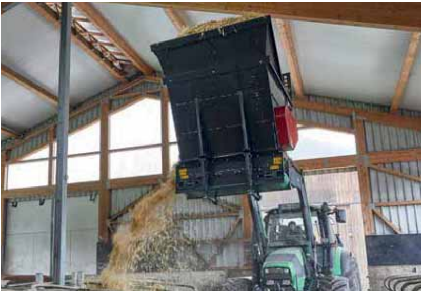
3 rouleaux de dosage équipés de lames
