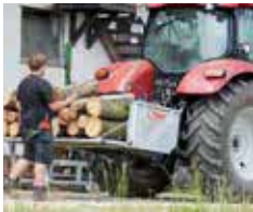
La paroi pendulaire rabattable peut servir de rallonge à la benne
