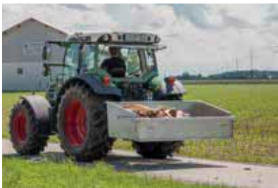
Déversement mécanique par câble de commande
