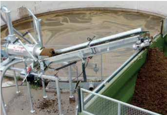
Illustration : bande de convoyage de 3,5 mètres de long pour recueillir les matières solides
