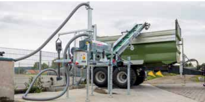
Illustration : bande de convoyage de 3,5 mètres de long pour recueillir les matières solides
