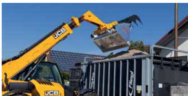
Broches de préhension de 20 mm d'épaisseur, en acier très résistant à l'usure (HB 500)
