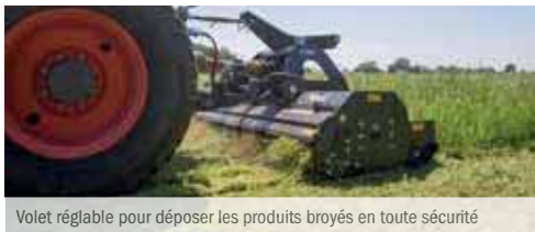
Volet réglable pour déposer les produits broyés en toute sécurité
