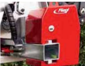
Contrepoids latéral - charge minimisée sur le balancier du véhicule porteur.
