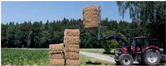
Illustration : pique botte à fond poussant avec serre-flan hydraulique sur le surélévateur - possibilité de transporter jusqu'à 3 balles rectangulaires
