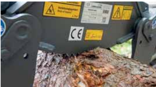
Illustration : dents affûtées pour un meilleur maintien
