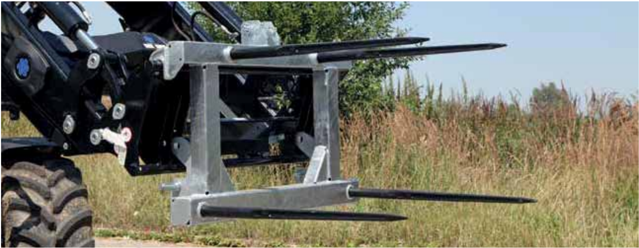
Illustration sans dispositif de surélévation avec 4 broches pour balles rondes (2 broches - supplément)
