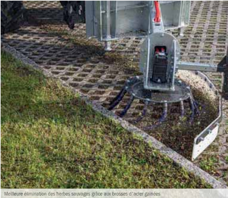
Meilleure élimination des herbes sauvages grâce aux brosses d'acier gainées
