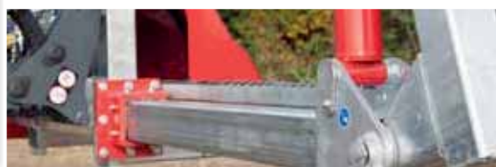
Expulsion latérale de série à paliers en plastique 1200 mm
