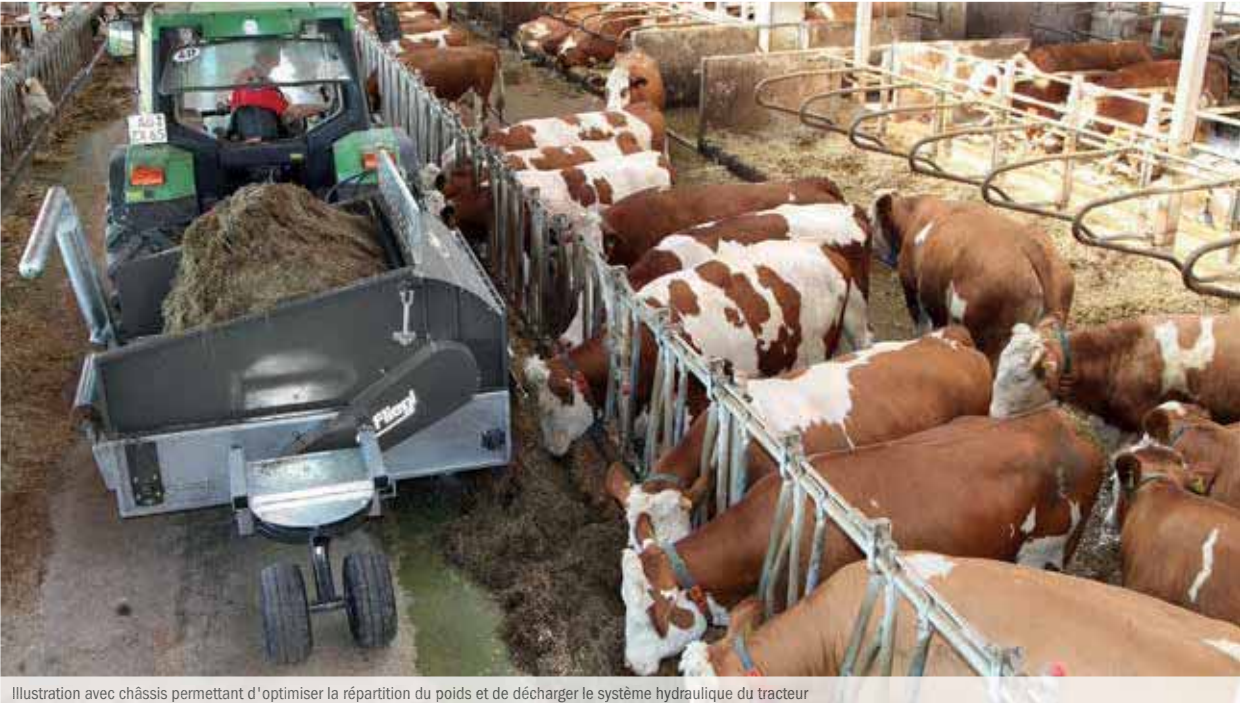
Illustration avec châssis permettant d'optimiser la répartition du poids et de décharger le système hydraulique du tracteur
