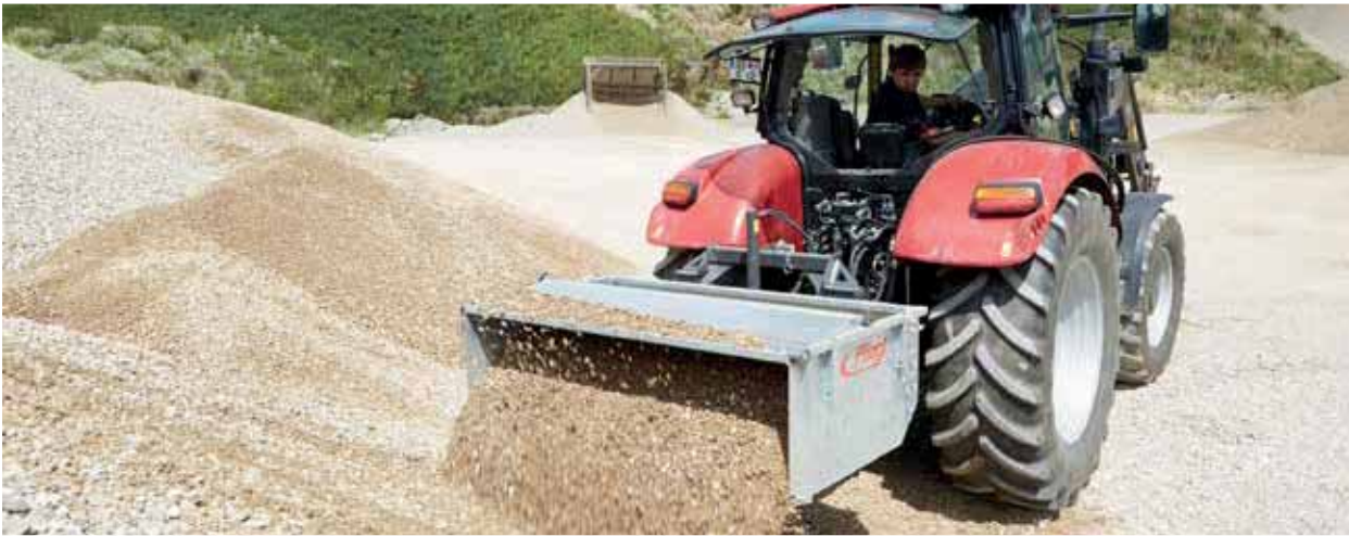
Pour charger une benne par ex. avec des céréales, des engrais chimiques, etc. Le bras d'extension particulièrement long permet d'atteindre une hauteur de basculement très élevée.
