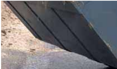
Les tôles de renforcement assurent une sous-structure stable
