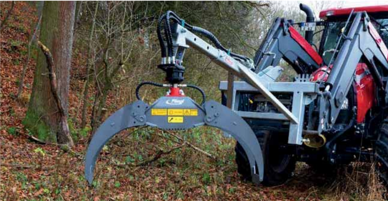
Pince de transbordement avec rallonge pour crochet de suspension (attelage trois points aux normes européennes) et moteur couple
