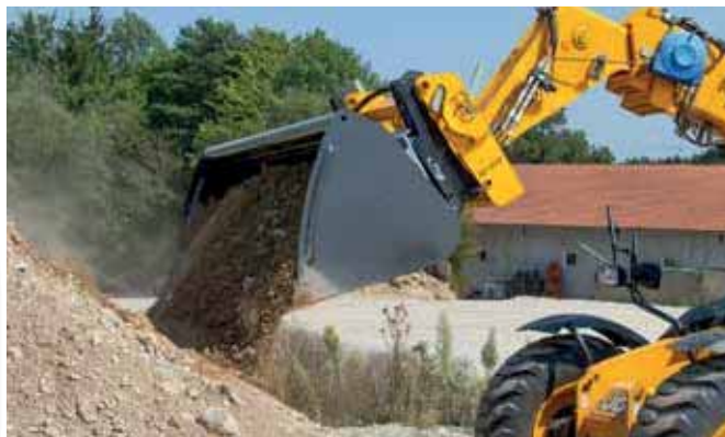
Construction conique permettant un meilleur glissement des produits en vrac
