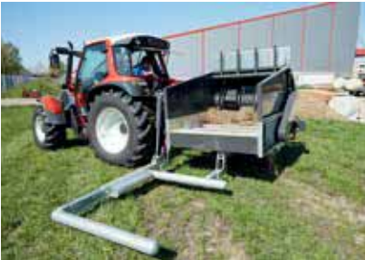
Illustration avec châssis permettant d'optimiser la répartition du poids et de décharger le système hydraulique du tracteur
