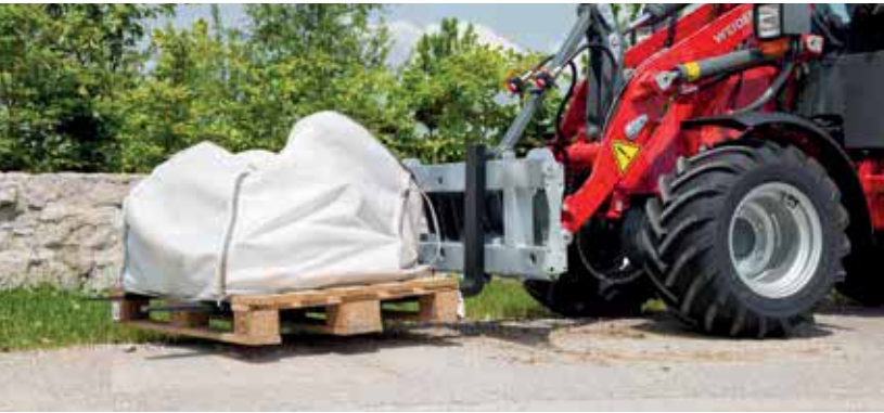
Montage et démontage très faciles en cas d'utilisation avec des broches pour balles rondes grâce aux douilles coniques existantes (à visser)
