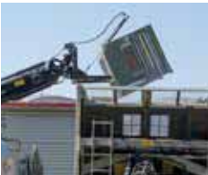
Angle de basculement jusqu'à 71° env. !
