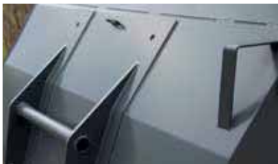
Aide à l'orientation pour le déchargement régulier sur le sol des matériaux en vrac
