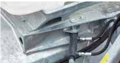
Tête pivotante hydr. avec pupitre de commande
