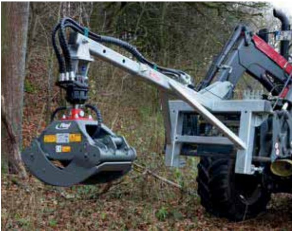
Pince de transbordement avec rallonge pour crochet de suspension (attelage trois points aux normes européennes) et moteur couple
