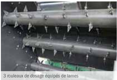
3 rouleaux de dosage équipés de lames
