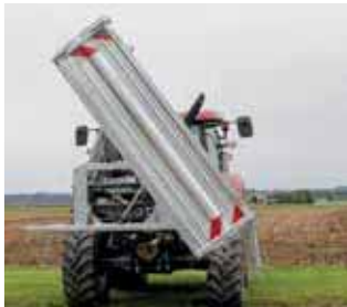
Angle de basculement latéral jusqu'à 50°
