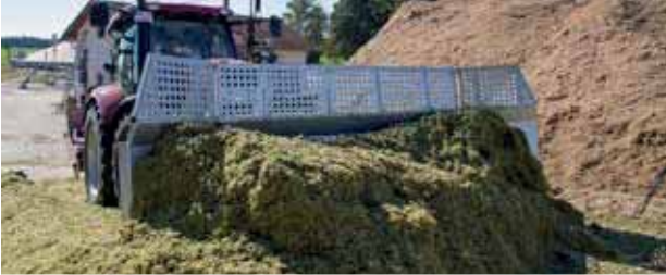
Grillage supplémentaire : surélévation (400 mm) sur toute la largeur de travail de la lame de nivellement. Le dispositif de surélévation est tout simplement vissé sur la lame de nivellement.
