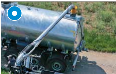
Nur für Pumpfässer: Absaugarm 8", Länge 5 m
