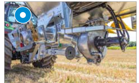
Bei Vakuumfasser: Turbobefüller mittig unter dem Fass –für beidseitiges Ansaugen
