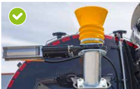
Andocktrichter hinten oben am Fass
