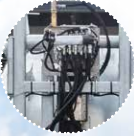
Steuerblock mit Ölfilter
