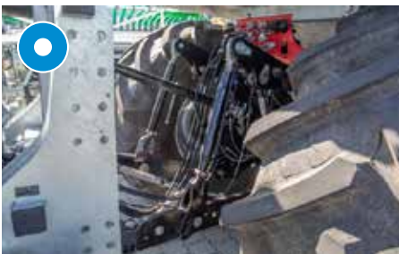
Dreipunkthydraulik wird beim Lenken der Achse mitgeführt
