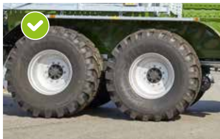
Radausschnitt und Bereifung Bereifung 750/60-R30,5" Optional: Bereifung 750/60-R30,5" hinten 850/50-R30,5 vorne
