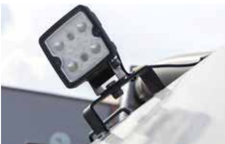
Arbeitsscheinwerfer für Ausleuchtung des Verteilers
