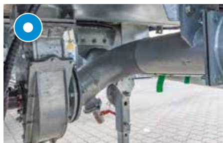
Turbobefüller hydraulisch, mittig unter dem Fass
