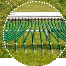
Gleichmäßige Verteilqualität durch kurze Auslaufschläuche
