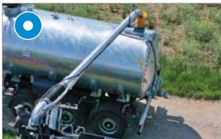
Nur für Pumpfässer: Absaugarm 8", Länge 5 m
