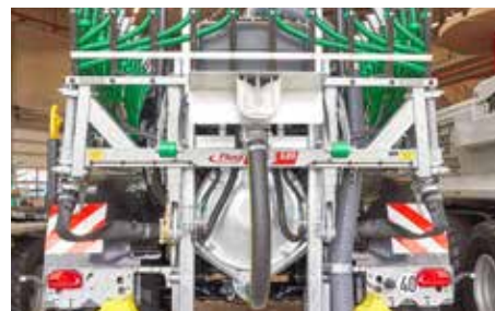
Zusätzliche Ausbringmöglichkeit mit angebautem Prallkopfverteiler
