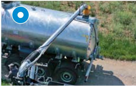
Nur für Pumpfässer: Absaugarm 8", Länge 5 m
