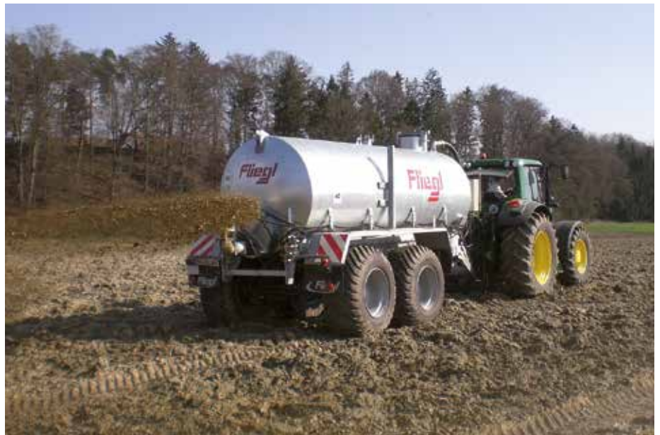
Pendelverteiler für grobtropfiges Ausbringen
