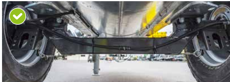
Gekrüpfte Achse bei 5000 - 8.600 Liter Niedriger Schwerpunkt sorgt für optimales Fahrverhalten am Hang
