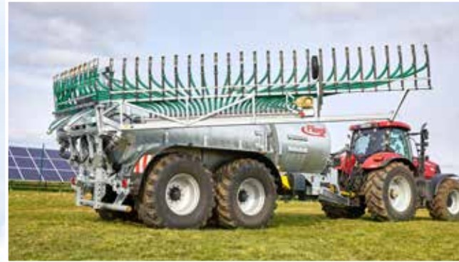
Keine abknickenden Auslaufschläuche durch speziellen Klappmechanismus
