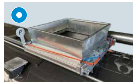
Pneumatischer Schubdeckel für externe Befüllung von oben
