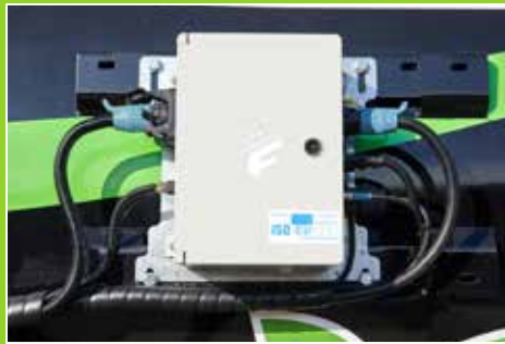
Schaltschrank FFC mit integriertem Jobrechner und ISOBUS-Schnittstelle
