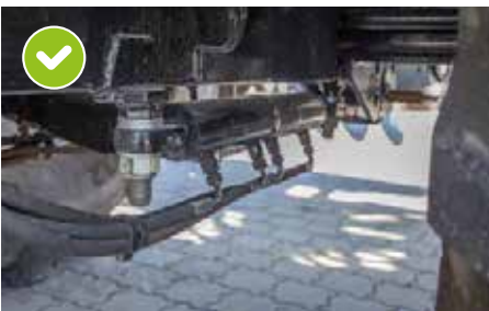
Achse zentral gelagert, hydraulische Lenkung für Fahrt im Hundegang
