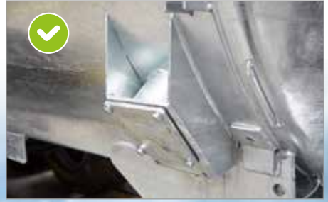
Nur bei Vakuumfass: Serienmäßig mit Blindflansch – vorne rechts und links sowie hinten
