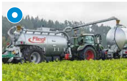
Absaugarm hydraulisch schwenkbar 8°
