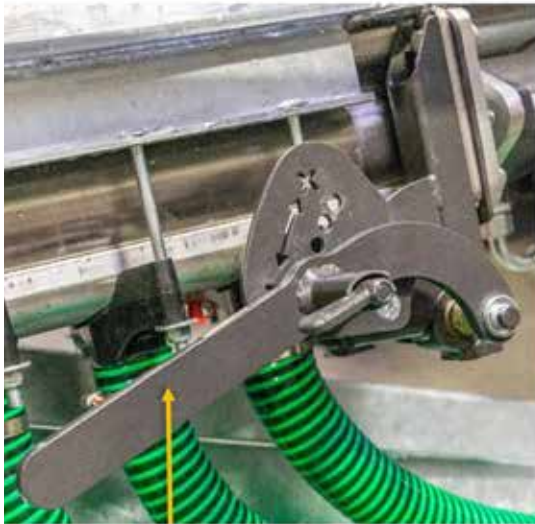
An diesem Hebel kann die Lochgröße mechanisch verstellt werden
