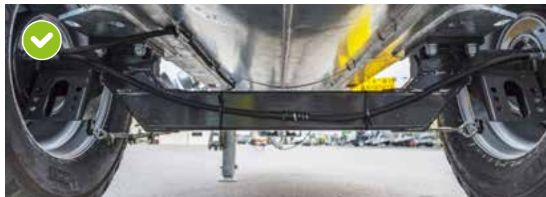
Essieu coudé de 5000 à 8600 litres Le centre de gravité bas garantit un comportement de conduite optimal dans les pentes
