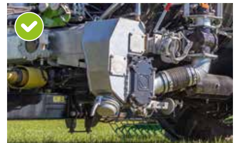
Entretien très facile : pompe à lobes rotatifs à entraînement mécanique avec réducteur
