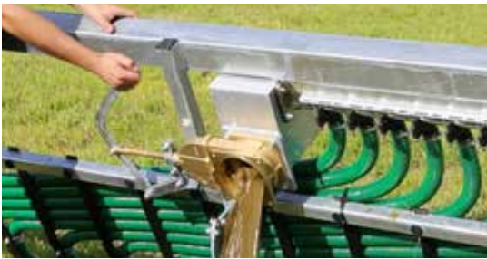
Collecteur pour corps étrangers, vidange mécanique ou hydraulique
