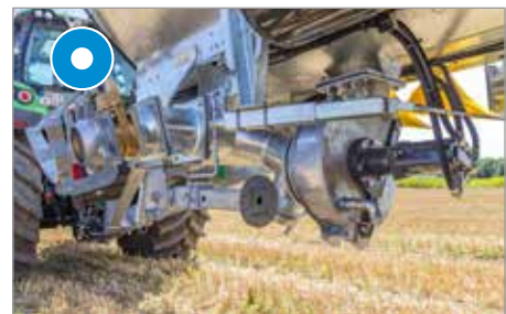
Sur citerne sous vide : accélérateur de flux Turbo au milieu sous la citerne – pour aspirer des deux côtés
