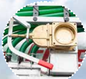
Collecteur à ouverture mécanique ou hydraulique
