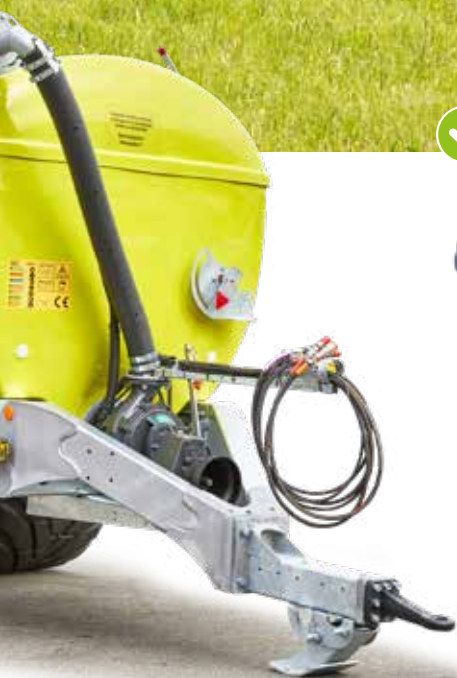
Pompe centrifuge Elba de Battioni 3500 ou 6500 L/min.
