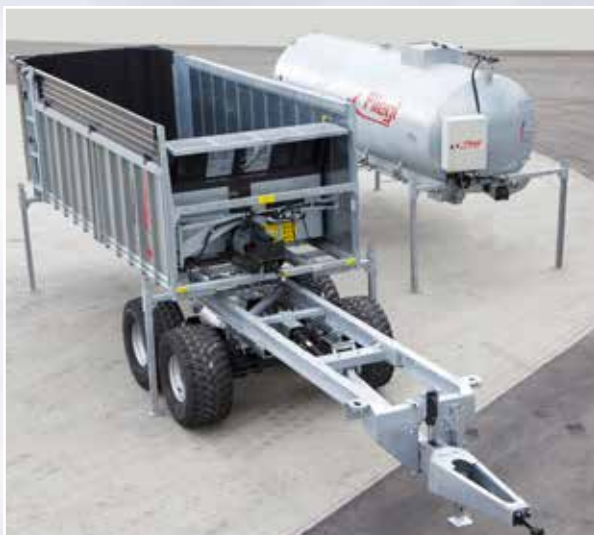
Le système à adaptation individuelle de Fliegl Cuves à lisier en option pour châssis de remplacement.
