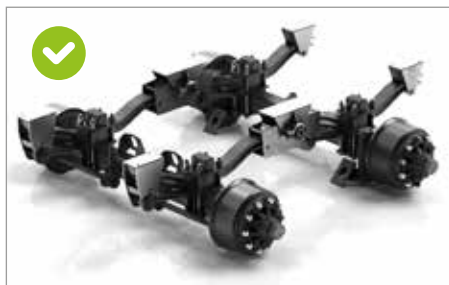
Train de roues « Gigant Plus » pour MAXX Line Plus 16 000 L et 18 000 L
