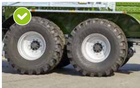
Découpe de roue et pneumatiques Pneumatiques 750/60-R30,5"
