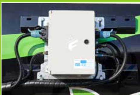
Armoire de distribution FFC avec système informatisé intégré et interface ISOBUS
