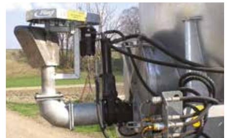
Rampe hydraulique avec une largeur de travail de 12 à 18 m.
