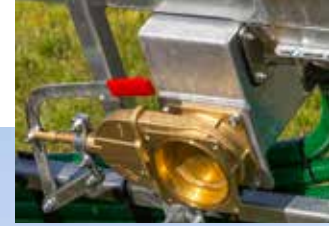
Collecteur de séparation des corps étrangers
