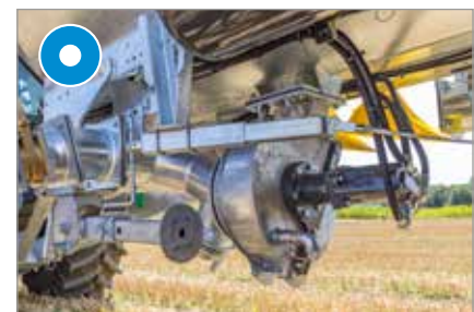
Sur citerne sous vide : accélérateur de flux Turbo au milieu sous la citerne – pour aspirer des deux côtés
