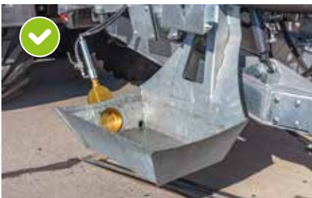
✓ Bac collecteur pour la potence d'aspiration Transfill avec vidange automatique sur le champ
