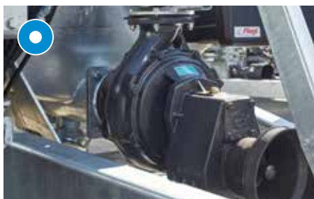
Pompe centrifuge pour le transbordement
