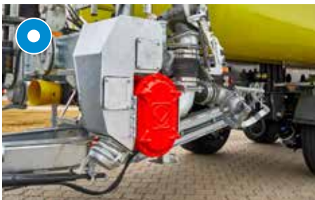
Entretien très facile : pompe à lobes rotatifs à entraînement mécanique avec réducteur
