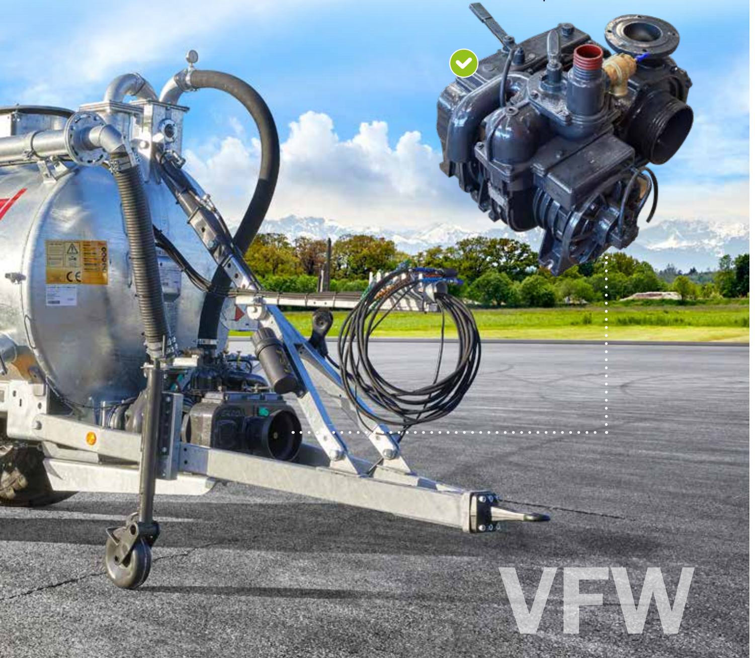
Pompe GARDA : pompe centrifuge et compresseur combinés
