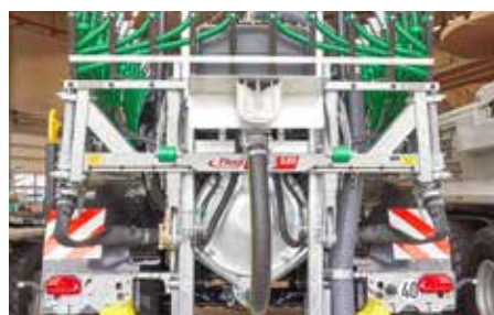
Possibilité d'épandage supplémentaire avec la buse d'épandage large installée
