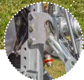
Compensation autom. de dévers pour une adaptation optimale au sol
