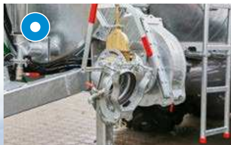
Citerne sous vide uniquement : accélérateur de flux Turbo avec système d'accouplement rapide latéral
