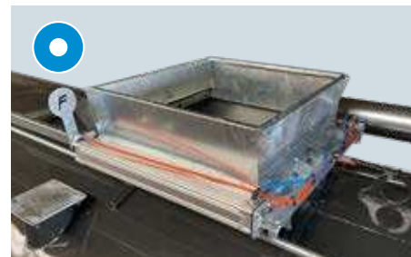
Couvercle de poussée pneumatique pour remplissage externe par le haut
