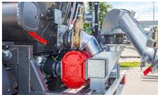
Pompe à vis puissante Vogelsang VX 186-260 Q avec fonction de reprise pour vider le tuyau à lisier
