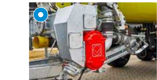
Entretien très facile : pompe à lobes rotatifs à entraînement mécanique avec réducteur
