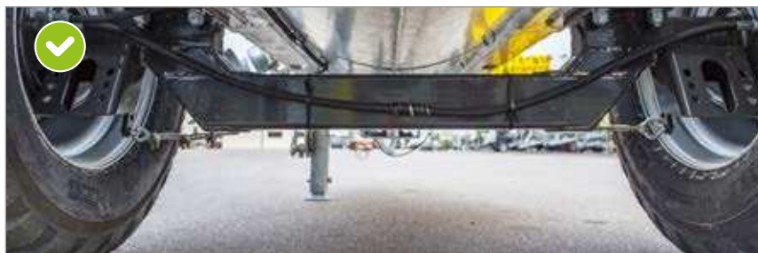
Essieu coudé de 5000 à 8600 litres Le centre de gravité bas garantit un comportement de conduite optimal dans les pentes
