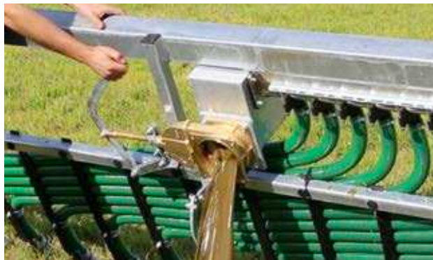
Collecteur pour corps étrangers, vidange mécanique ou hydraulique
