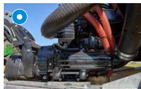
Compresseur : Battioni BLW 360 36000 Liter/min ou BLW 240 24000 Liter/min
