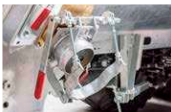
Pièce en M pour système d'accouplement rapide 6"
