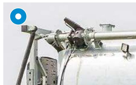
Conduite de rinçage avec vanne 3 voies pour une meilleure fonction de mélange
