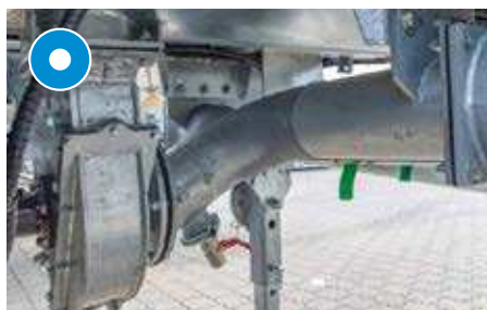
Accélérateur de flux Turbo hydraulique, au milieu sous la citerne
