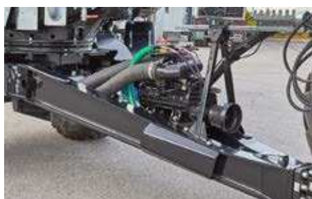
Hitzebeständiger Kompressor 13.500 mechanisch angetrieben
