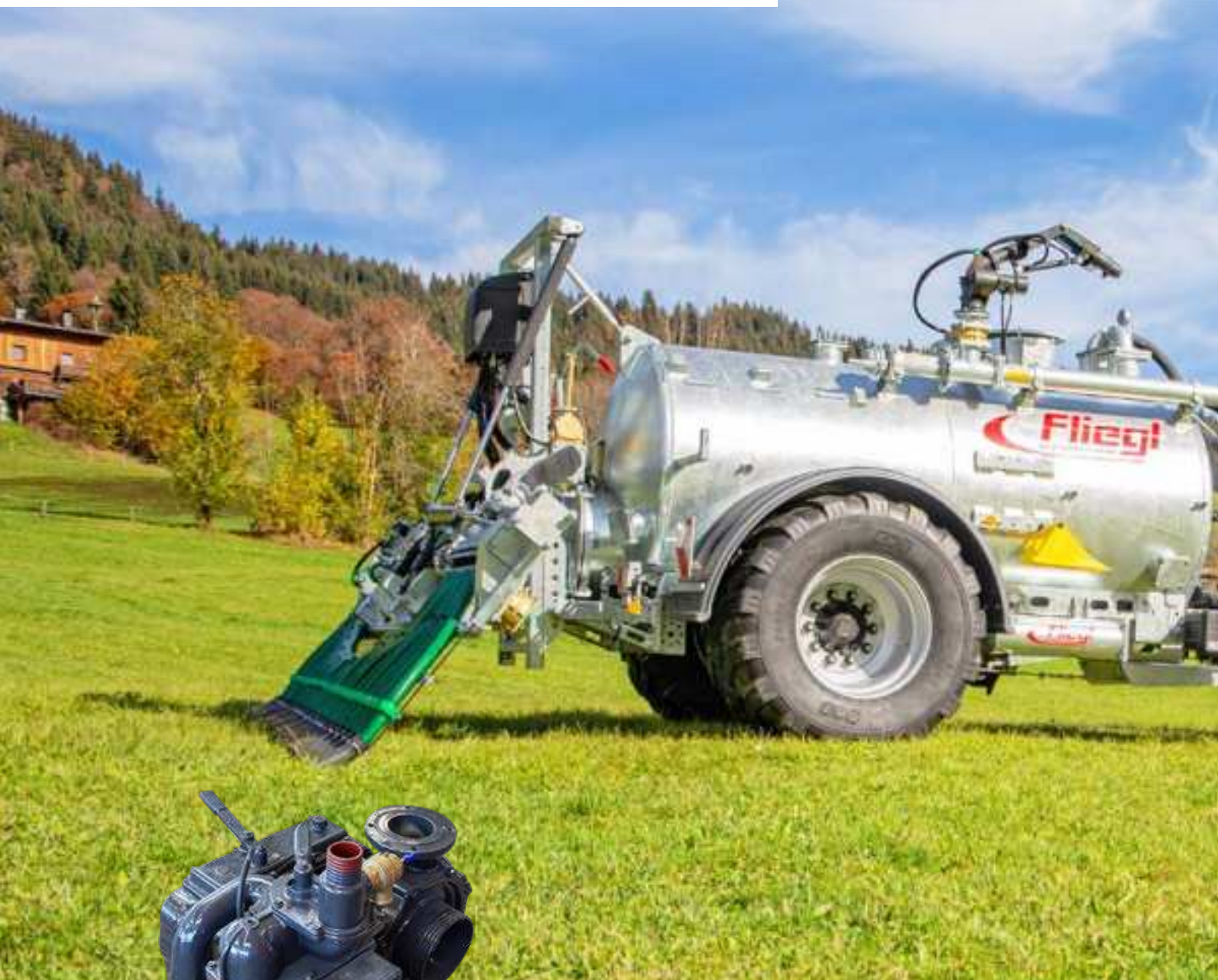
Pompe GARDA : combinaison d'une pompe centrifuge et d'un compresseur.
