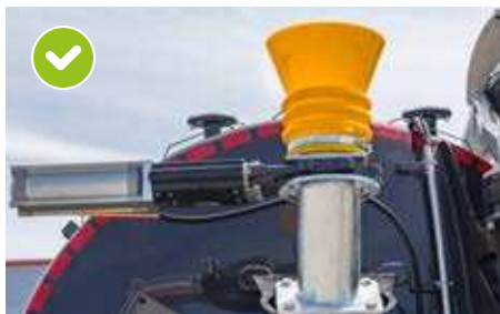
Trémie d'accrochage à l'arrière, en haut sur la citerne
