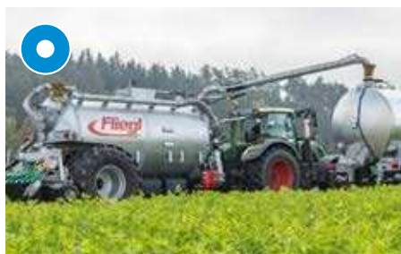
Bras d'aspiration à pivotement hydraulique 8"
