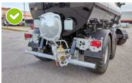
Raccord rapide 6" orientable à 130°
