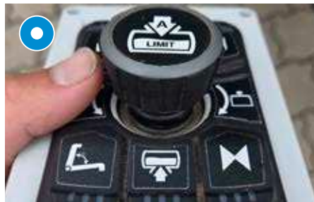
Commande proportionnelle du bras « Éléphant » via joystick
