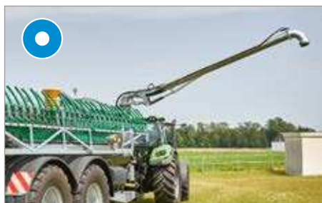
Citernes à pompe uniquement : bras d'aspiration 8", longueur 5 m
