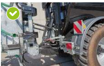
Attelage à quatre points avec une capacité de levage d'environ 6 tonnes
