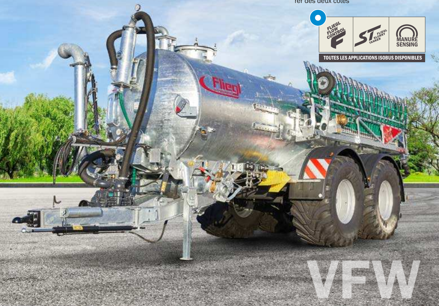
Sur citerne sous vide : accélérateur de flux Turbo au milieu sous la citerne – pour aspirer des deux côtés
