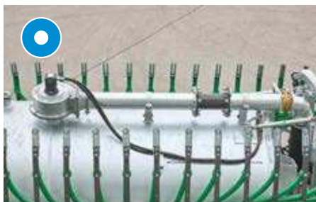
Accélérateur d'épandage monté en haut côté cuve
