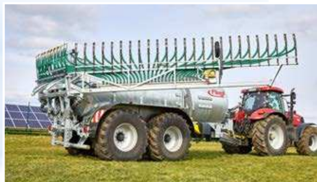
Tuyaux d'écoulement protégés contre les plis par le mécanisme de basculement spécial
