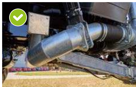
Système by-pass pour le turboremplisseur avec 2 vannes 10", permettant l'aspiration et le refoulement du lisier via le bras « Éléphant »
