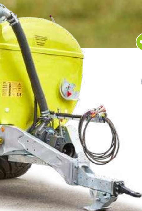
Pompe centrifuge Elba de Battioni 3500 ou 6500 L/min.
