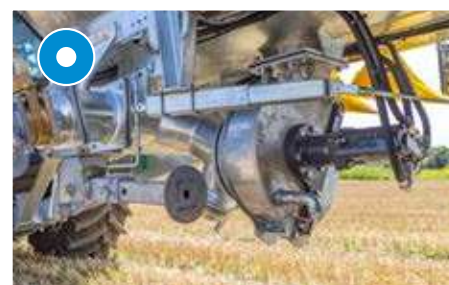
Sur citerne sous vide : accélérateur de flux Turbo au milieu sous la citerne – pour aspirer des deux côtés
