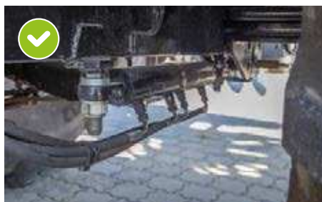
Essieu central, direction hydraulique pour marche en crabe
