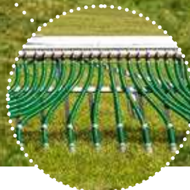
Qualité constante de la répartition grâce aux tuyaux d'écoulement courts
