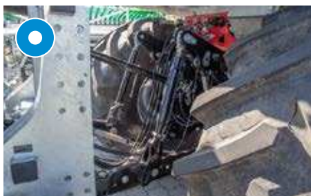
L'hydraulique à trois points est également entraîné lors du braquage de l'essieu
