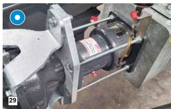
28. Couteau de broyage pour l'aspiration – à entraînement hydr. (uniquement possible sur les citernes Alpha et Poly Line dotées d'une pompe à vis excentrique)
