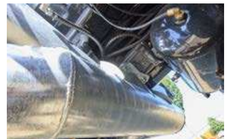
Système by-pass pour le turboremplisseur avec 2 vannes 10", permettant l'aspiration et le refoulement du lisier via le bras « Éléphant »
