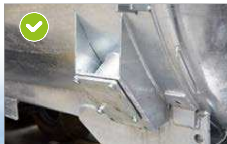
Citerne sous vide uniquement : bride pleine de série – à l'avant à droite et à gauche ainsi qu'à l'arrière
