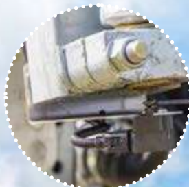
Capteurs angulaires à gauche et à droite pour une ouverture et une fermeture régulières dans les pentes
