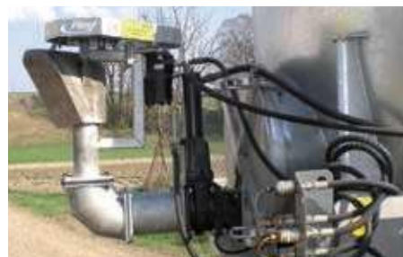
Rampe hydraulique avec une largeur de travail de 12 à 18 m.
