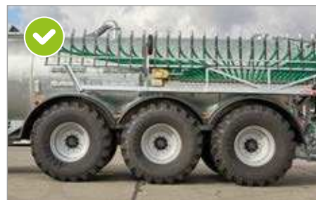
Découpe de roue en combinaison avec une suspension hydr.
