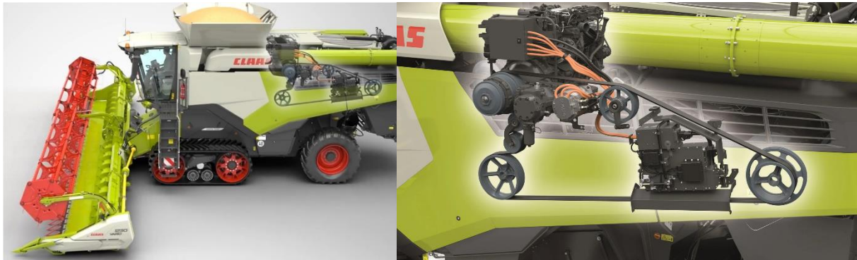
Oben: In einem Mähdrescher der Klasse 12 besteht das hybride Antriebssystem aus einem 400-kW-Dieselmotor, einem 40-kW-Elektromotor und einer 3-kWh-Batterie.
