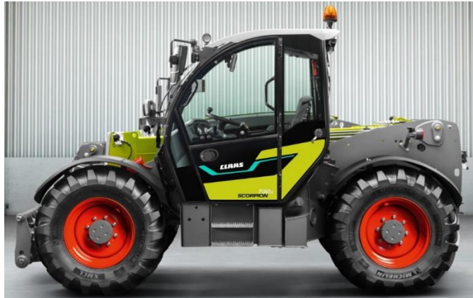
Der SCORPION 732e Prototyp bietet bis zu vier Stunden Reichweite am Stück. Dank 22 kW Onboard-Ladegerät können Landwirte Strom aus eigener Photovoltaik oder Biogasanlage zum Laden der Batterie nutzen.
