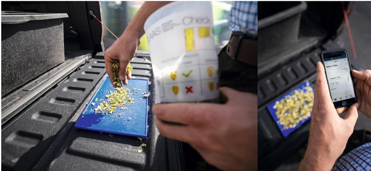
Alors qu'un laboratoire était jusqu'ici nécessaire pour effectuer les analyses, celles-ci peuvent désormais être exécutées directement durant la récolte grâce à une appli sur la nouvelle plateforme CLAAS connect qui permet de déterminer le degré de conditionnement du grain.
