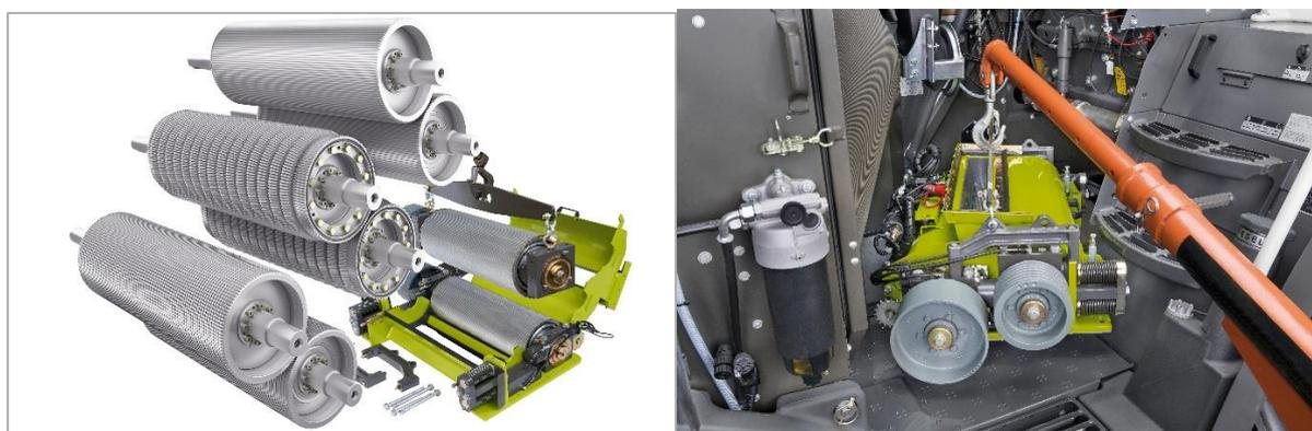
*Les éclateurs MCC CLASSIC et MCC MAX travaillent désormais avec un différentiel de vitesse jusqu'à 40 %, le modèle MCC CLASSIC étant également proposé avec une denture fine. Grâce à un espace service plus généreux, le module éclateur est désormais plus accessible et peut être monté et démonté plus rapidement et plus facilement pour son entretien.*
