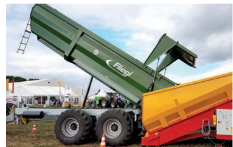
Langer Überhang bei TMK Potato zum Befüllen von Bunker
