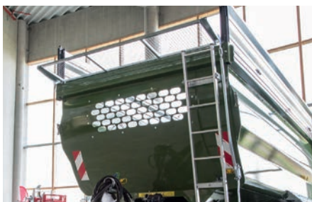
Mechanisch klappbares Schutzgitter
