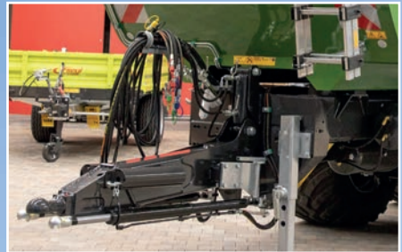
Zugleinrichtung hydraulisch gefedert
