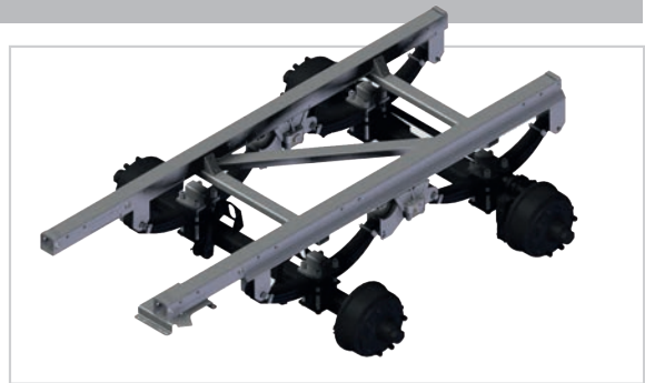
Tandemaggregat Gigant – Parabelfederung
