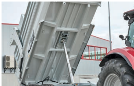
Schwerer Brückenrahmen für extreme Verwindungssteifheit
