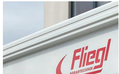
Versteifungsprofile aus einem Stück gekantet und gerundet
