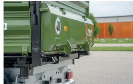
robuste klappe mit 2-Zylinder Ausführung
