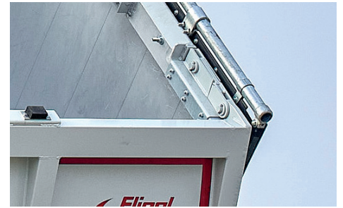
Doppelgelenkscharnier und 2-fache Hakenverriegelung
