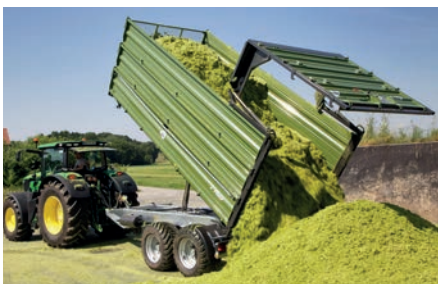
Silierkipper mit hydraulischer Rückwand
