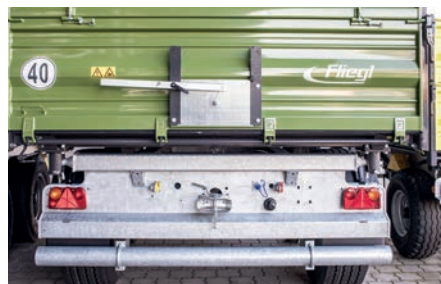
40 km/h Ausführung mit Unterfahrschutz und Kotflügel
