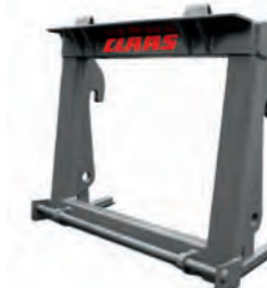
2. Vorsatzgeräteträger für Feldhäcksler. Der Vorsatzgeräteträger eignet sich für sämtliche Vorsätze der CLAAS JAGUAR Feldhäcksler Typen 497, 496, 494, 493 und 492, 491
