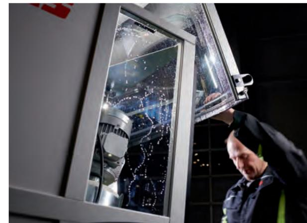
AQUA NON STOP COMFORT facilement et rapidement, directement après utilisation. Le flexible avec douchette est placé à portée de main, sur le côté de la machine, et permet un nettoyage ciblé de l'espace de travail. Le nettoyeur est alimenté par une pompe immergée dans le bain.
