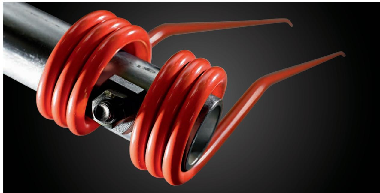
Les dents élastiques CLAAS ORIGINAL pour presses, remorques autochargeuses, ensileuses, andaineurs et faneuses assurent un flux de récolte régulier. Les spires des ressorts leur permettent de fléchir en cas de choc contre un corps étranger. Toutes les dents élastiques CLAAS répondent à des exigences de qualité élevées. Leur fabrication est soumise à un processus spécifique, subdivisé en 5 étapes :
