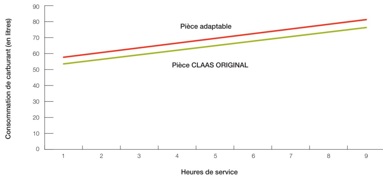
La pression différentielle élevée avec le filtre adaptable et la sollicitation plus importante du moteur se reflètent dans une consommation de carburant plus élevée.
