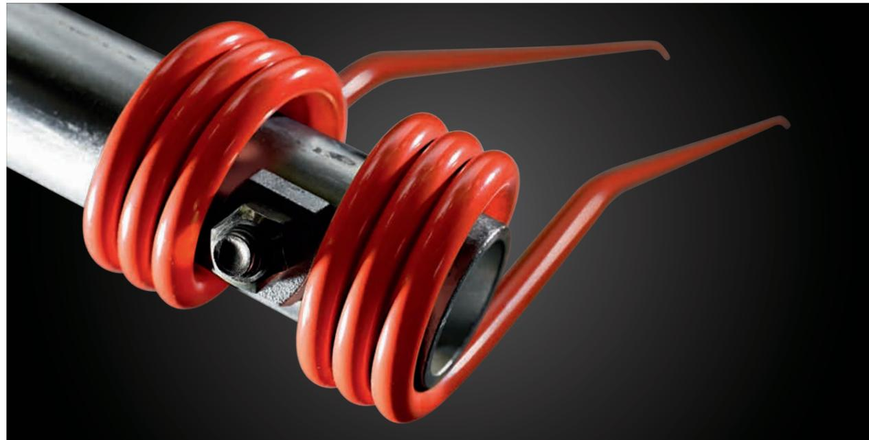
CLAAS ORIGINAL Federzinken ermöglichen einen reibungslosen Materialfluss bei Pressen, Ladewagen, Häckslern, Schwadern und Wenden. Durch ihre Windungen entsteht eine (Dreh-)Federwirkung, die ein Ausweichen bei Fremdkörpern ermöglicht. Bei CLAAS erfüllen sämtliche Federzinken in allen Einsatzbereichen hohe Qualitätsstandards. Ihr spezieller Fertigungsprozess gliedert sich in 5 entscheidende Schritte:
