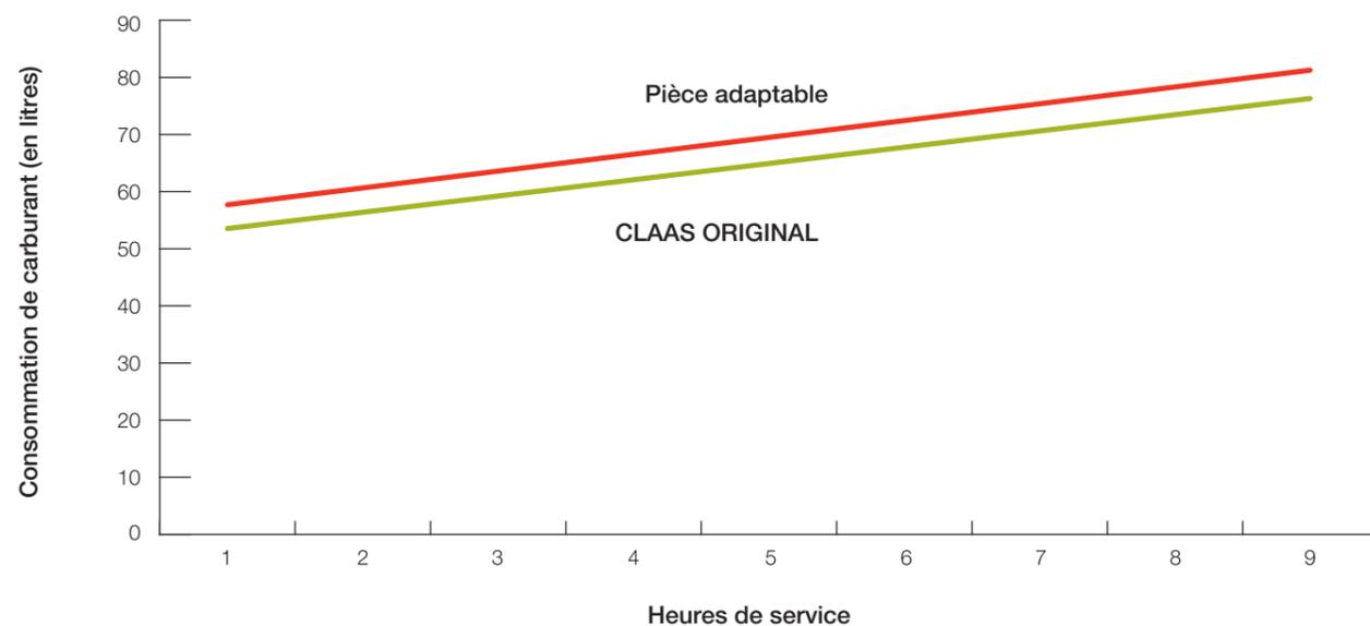
La pression différentielle élevée avec le filtre adaptable et la sollicitation plus importante du moteur se reflètent dans une consommation de carburant élevée.
