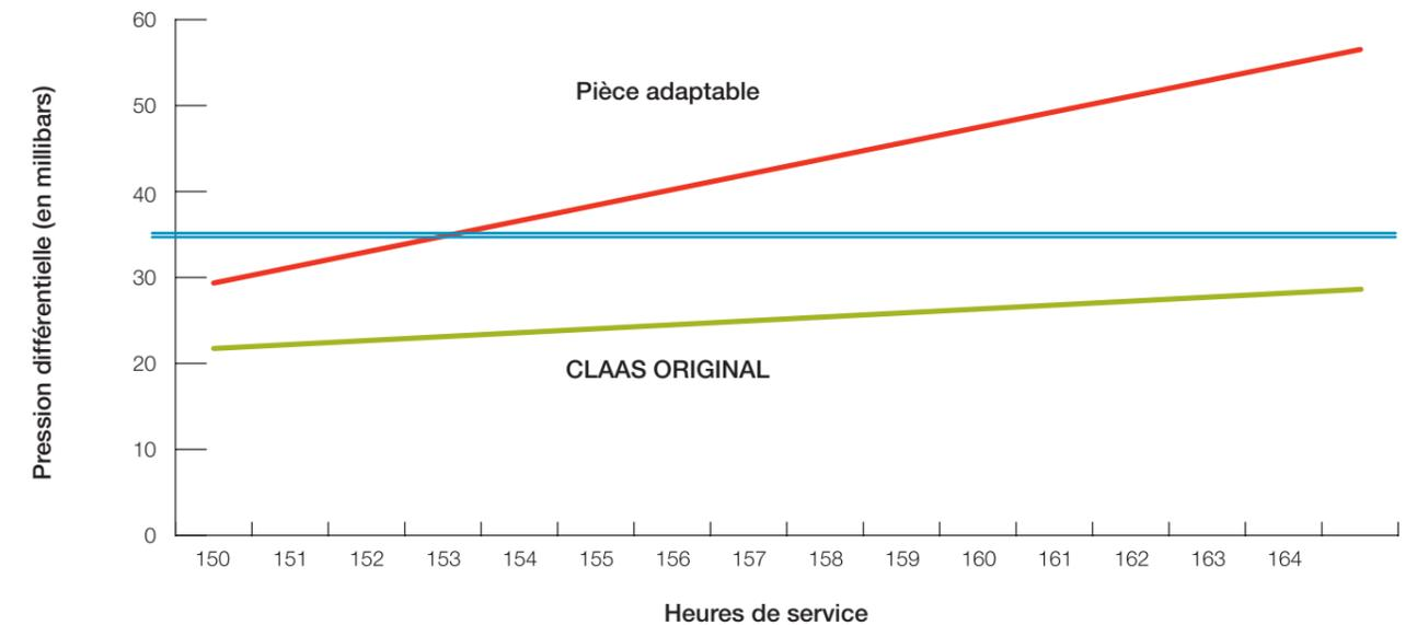
Après 164 heures de service, le filtre adaptable doit être remplacé. La pression différentielle est tellement élevée que le filtre doit être nettoyé pendant le service. Le filtre CLAAS ORIGINAL est encore efficace et devra simplement être nettoyé à la fin de la journée. Il peut encore être utilisé par la suite.
