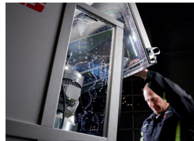
utilisation. Le flexible avec douchette est placé à portée de main, sur le côté de la machine, et permet un nettoyage ciblée de l'espace de travail. Le nettoyeur est alimenté par une pompe immergée dans le bain.
