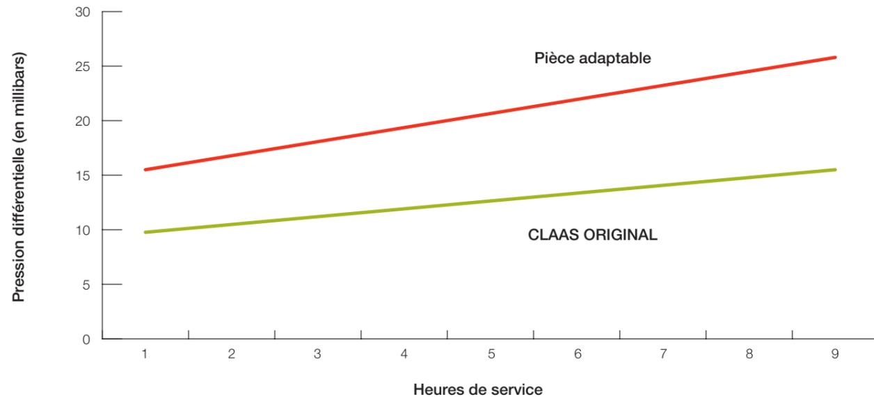
Les pressions différentielles du filtre à air ORIGINAL sont, dès le début, nettement inférieures aux pressions différentielles du filtre adaptable. Le moteur est donc moins sollicité avec la pièce CLAAS ORIGINAL.
