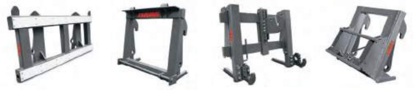
1. Porte-outils frontaux pour moissonneuses-batteuses. Le porte-outil frontal est adapté à tous les outils frontaux des gammes de moissonneuses-batteuses CLAAS LEXION, TUCANO et AVERO.
