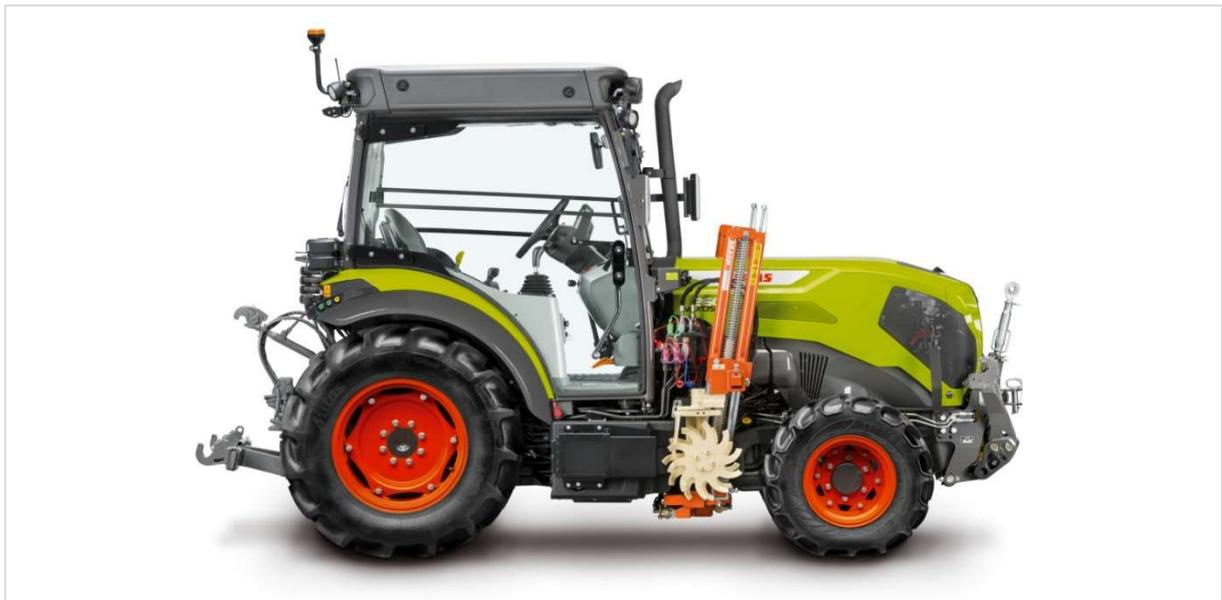
*Dank Mittelachsenbaumöglichkeiten lassen sich fortan noch mehr Arbeitsgänge kombinieren – beispielsweise für die mechanische Unkrautbekämpfung im Weinbau.*
