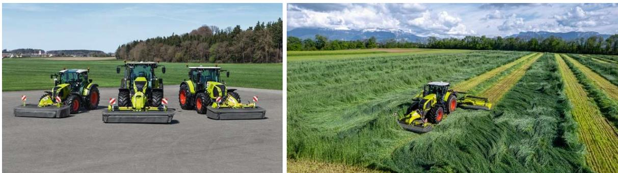
324386/803123: Die drei DISCO Frontmähwerke-Baureihen DISCO 3150F, DISCO F PROFIL und DISCO MOVE übernehmen das neue Design mit grauen Schutztüchern von den Heckmähern. FRC-Modelle mit Rollenaufbereiter können fortan optional mit dem doppelten Walzenantrieb für besonders massenreiche Bestände geliefert werden.
