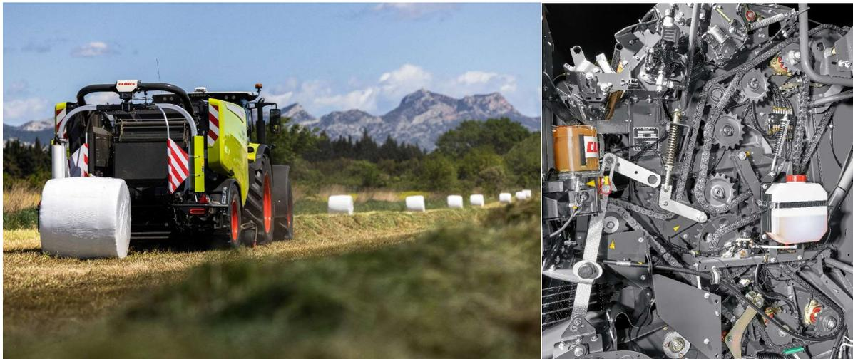
*Verstärkte Antriebe und die leistungsfähige Schmierung mit großem Kettenölbehälter garantieren eine lange Lebensdauer bei gleichzeitig verringertem Wartungsaufwand.*
