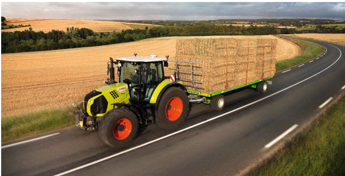
Die automatische Anhängerstreckbremse unterstützt bei Transportarbeiten und bei der Arbeit mit Ausbringfässern und Ballenpressen in Hanglagen.
