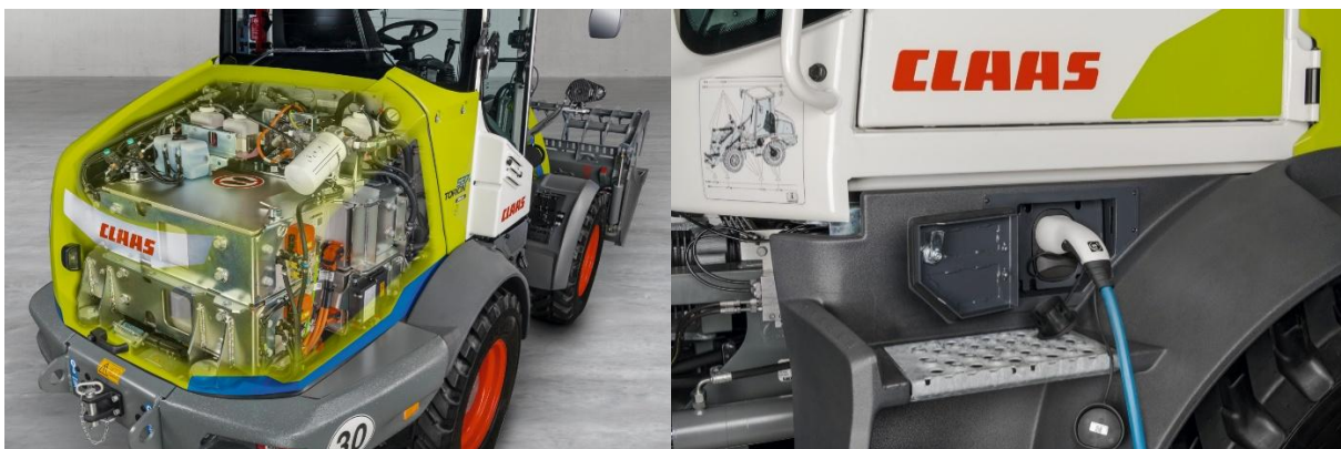
Der Lithium-Ionen-Akku mit modulare Batteriekonzept ist wahlweise mit 32,2 oder 64,4 kWh Kapazität verfügbar. Damit lassen sich im Praxisalltag Laufzeiten von bis zu 16 Stunden erreichen. Das integrierte On-Board-Ladesystem ermöglicht schnelles und einfaches Laden.
