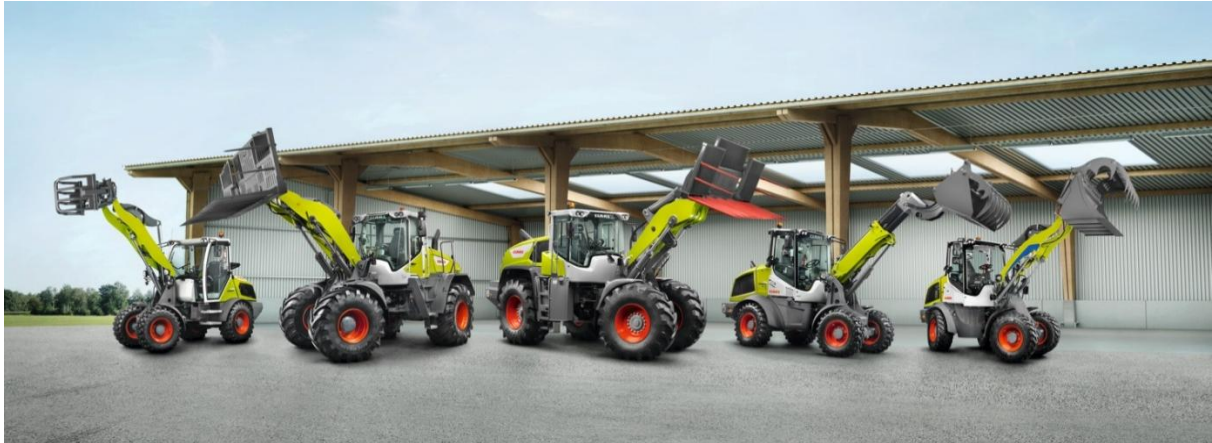
Der neue TORION 537e SINUS (rechts im Bild) ergänzt ab sofort das umfassende Radladerportfolio von CLAAS. Er eignet sich insbesondere für den lokal emissionsfreien, geräuscharmen Einsatz in der Tierhaltung und ist als Nutzfahrzeug mit klimaschonendem Antrieb in einigen Ländern und Bundesländern förderfähig.
