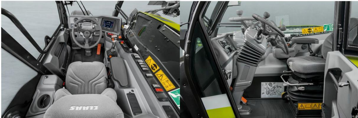
*Ergonomie und Komfort auf höchstem Niveau: Die neue Kabine mit verbesserter Rundumsitz, neu angeordneten Bedienelementen und leistungsstarker Klimaanlage. Die Joystickbedienung ist griffgünstig vor der rechten Armablage am Fahrersitz befestigt.*
