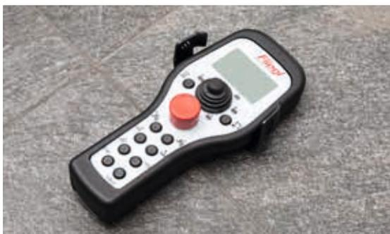
Steuerung über Funkfernbedienung
