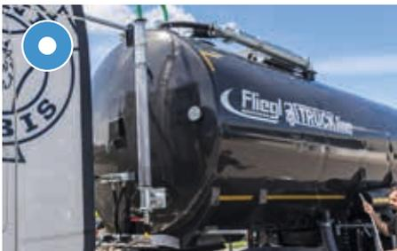
Zusätzliche Füllstandanzeige durch Plexiglasrohr
