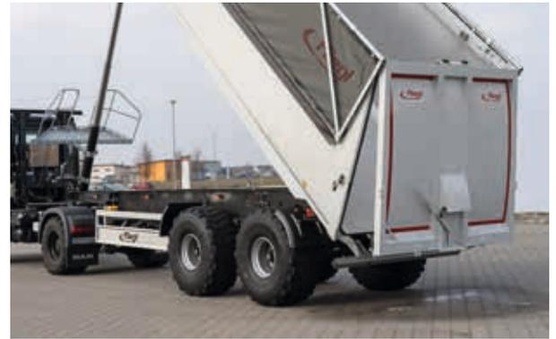
4 Spannschlösser für Gerteidetransport sowie Abladung über Kornschieber. Umlaufende Gummidichtung in Verbindung mit Spannschlössern auch für feuchte Schüttgüter.
