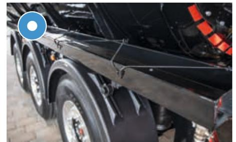
Schlauchwanne für Saugschlauch
