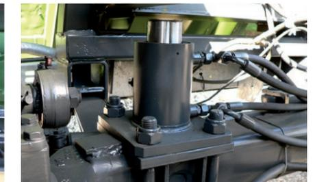
Optional: Hydraulische Abstützung auf die Achse
