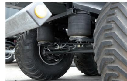
Optional: Luftfederung mit automatischer Kippabsenkung
