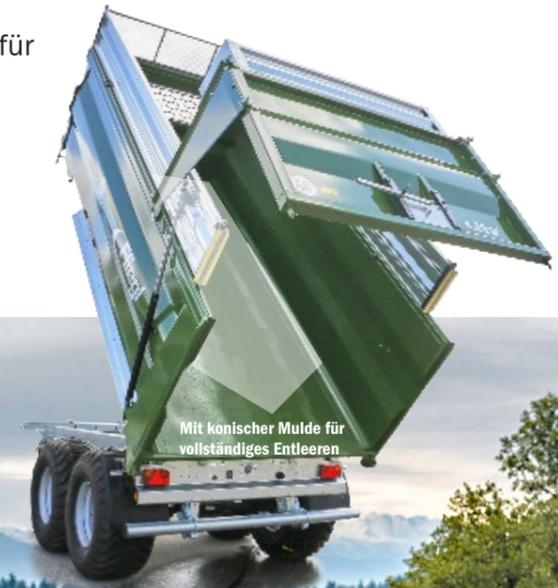
Mit konischer Mulde für vollständiges Entleeren
