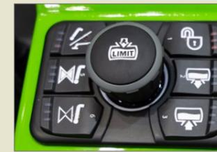
Bedienpult mit Joysticksteuerung für Saugarm
