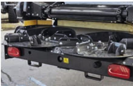
**2 Streuteller mit je 6 Wurf-schaufeln** sorgen für eine gleichmäßige Verteilung der Streugüter. Die Wurf-schaufeln sind mit Hartmetallplatten bestückt.
