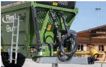
**Hydraulisch gefederte Zugdeichsel.**
