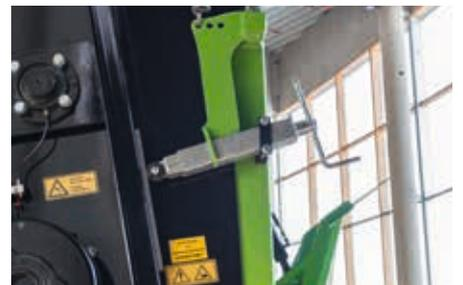
Über die beiden Spindeln links und rechts kann für den unteren Teil der Rückwand die **Neigung** und somit der optimale Aufgabepunkt des Streuguts auf den Streutellern eingestellt werden.
