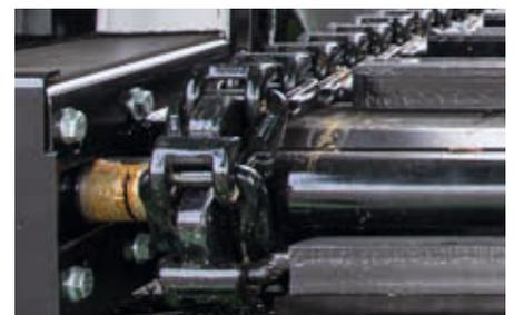
**Sternförmige Kettenräder** mit geringer Verschmutzungsanfälligkeit
