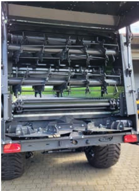
**2 Fräswalzen mit drehbaren Zinken** aus verschleißfesten Stahl sorgen für beste Materialauflösung. Als Wickelschutz sind Stäbe eingeschweißt, um die Reinigung der Fräswalzen zu erleichtern. Die Fräswalzen sind kardanisch angetrieben und gegen Überlast abgesichert.
