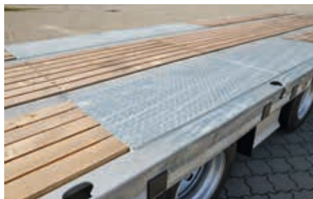
Auffahrampen und Brückenboden aus Weichholz
