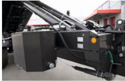
Bordhydraulik 60 Liter (optional 90 L) angetrieben durch Zapfwellenantrieb Hydraulikpumpe und Ölbehälter
