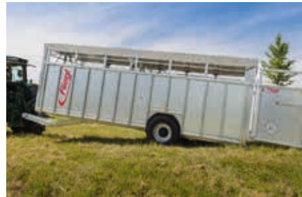
Hydraulische Kippdeichsel sorgt für einen optimalen Ein- und Ausstieg
