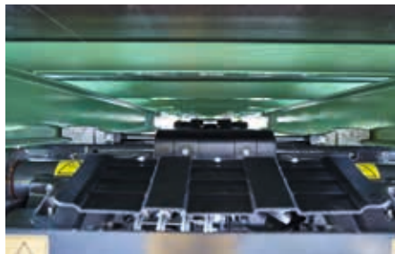
Umsteckbares Verriegelungssystem für Innen- und Aussenverriegelung
