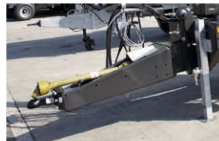
Drehbarer Zugholm für Oben- und Untenanhängung
