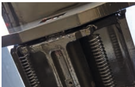
Automatische Hakenverriegelung beim Kippvorgang
