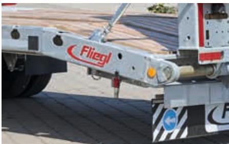
Brücke hinten auf ca. 900 mm abgeschrägt
