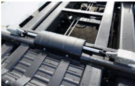
Umsteckbares Verriegelungssystem für Innen- und Aussenverriegelung
