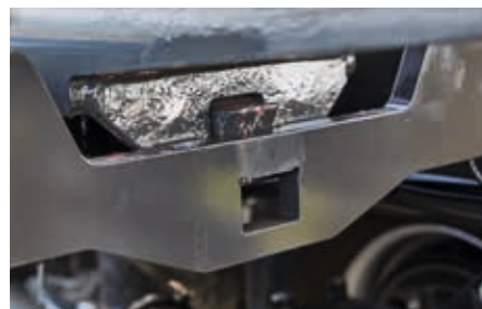
Drehbarer Zugholm für Oben- und Untenanhängung
