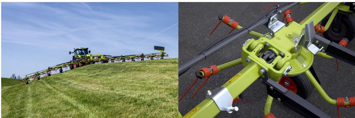
*Weiterentwickelte, massive PERMALINK HD Fingerkupplungen für zuverlässigen Antrieb und maximale Boden Anpassung.*
