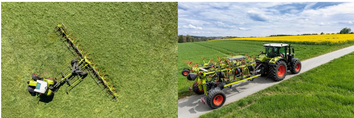
*Die großen Fahrwerksräder führen den Wender bodenschonend und leichtzünftig im Feld. In der TS Variante sind die Räder mit einer Nachlauflenkung für noch mehr Wendigkeit und Narbenschonung ausgestattet.*
