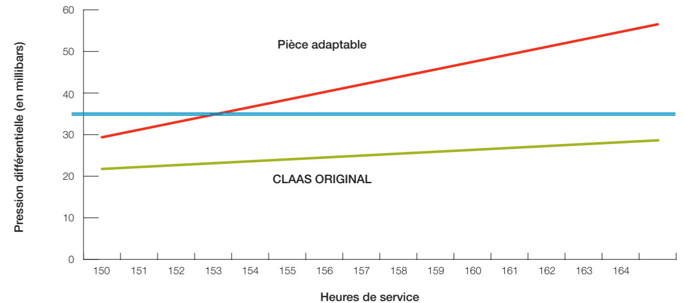
Pression différentielle après 164 heures de service
