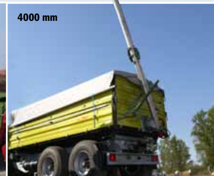
Überladeschnecken in 3000 und 4000 mm-Ausführung, Ø 150 mm, verzinkt oder aus Edelstahl, leicht zu montieren, mit Seilwinde verstellbar, Laufräder zum Transport.
