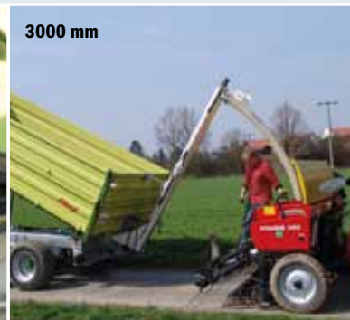
Überladeschnecken in 3000 und 4000 mm-Ausführung, Ø 150 mm, verzinkt oder aus Edelstahl, leicht zu montieren, mit Seilwinde verstellbar, Laufräder zum Transport.
