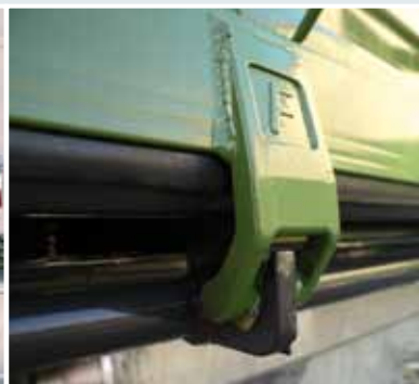
Zentralverriegelung seitlich, ab EDK 60 serienmäßig. Ab 4.500 mm Brückenlänge 6-fach verriegelt, durchgehendes nicht eingeschnittenes Brückenprofil.
