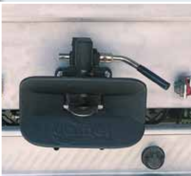
Automatische Anhängerkupplung mit Hydraulik- und Bremsanschluß für zweite Anhänger.
