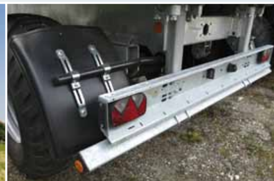
40 km/h Ausführung mit Unterfahrerschutz und Kotflügel.
