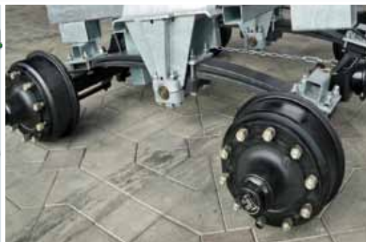
Titan-Tandemaggregat für besten Bodenausgleich, schmierlos und wartungsfrei.
