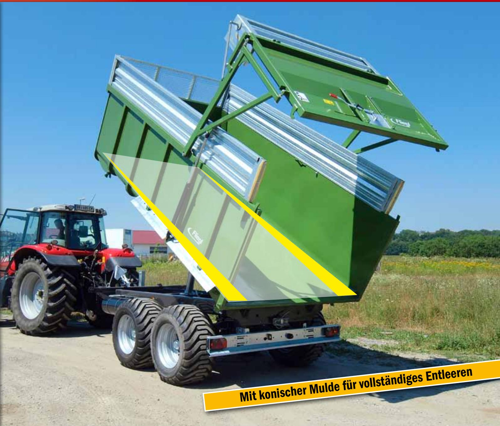
Mit konischer Mulde für vollständiges Entleeren
