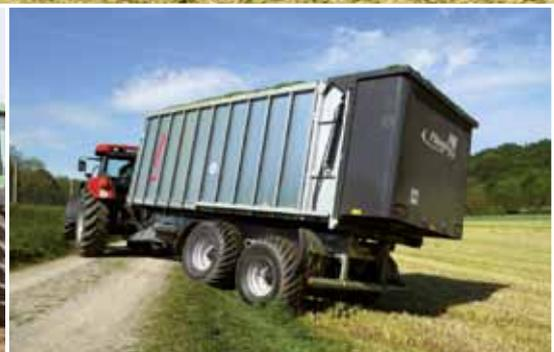
Höchste Standsicherheit beim Kippen durch geringen hinteren Überstand der Mulde hin zur Achsmittle sowie der hydraulisch betätigte Großraumrückwand, die beim Öffnen in Richtung Achsmittle schwenkt.
