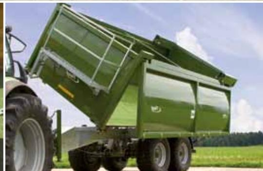
Tandem-Dreiseiten-Muldenkipper, extrem Robust durch verstärkte Seitenwand.
