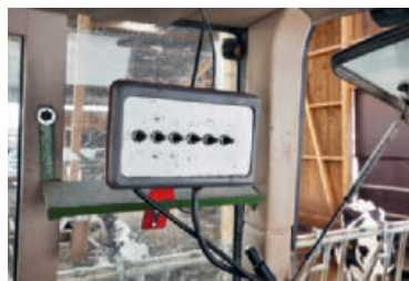
La Trioliet «Triomix 1-1200» est dotée de série d'une télécommande électrique.
